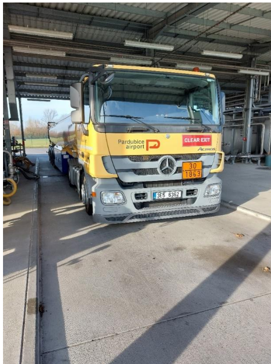
Obrázek 10 Současná automobilová cisterna pro distribuci leteckého petroleje.
