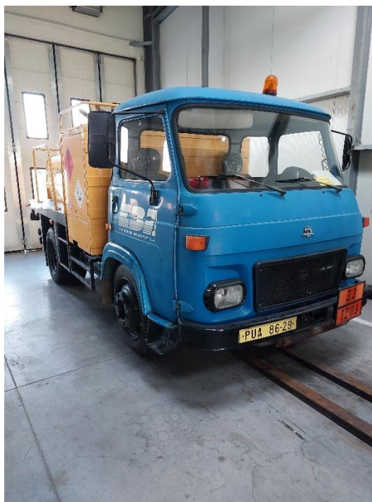
Obrázek 11 Obrázek 11 Současná automobilová cisterna pro přepravu leteckého benzínu. Zdroj: autor 2024.
