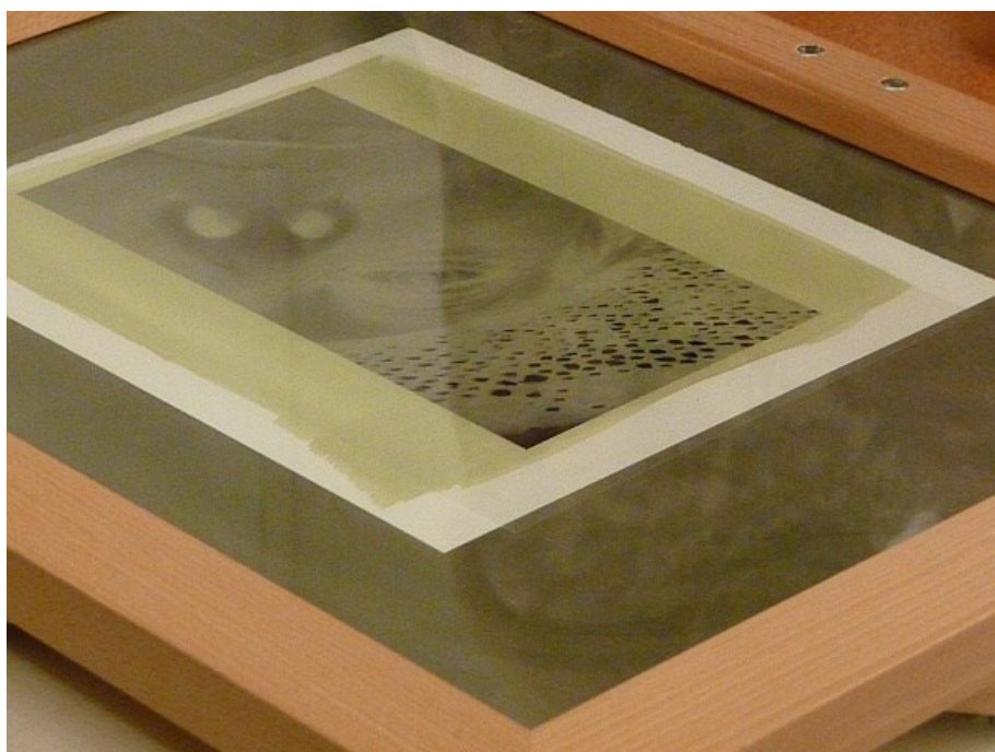
Foto 37: Kopírovací rám s negativem a zcitlivěným papírem (zdroj: fytotechniky.cz)
