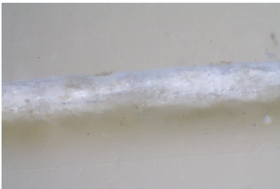
Foto 59: Stratigrafie vrstev kolodiové přímo kopírující fotografie při zvětšení 100x
