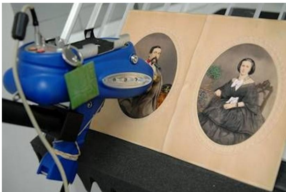
Foto 3: Měření prvkového složení fotografie pomocí XRF (zdroj: archiv GCI)
