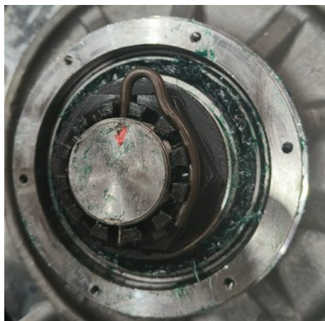
Obrázek 19: Detail zajištěného disku pomocí matice
