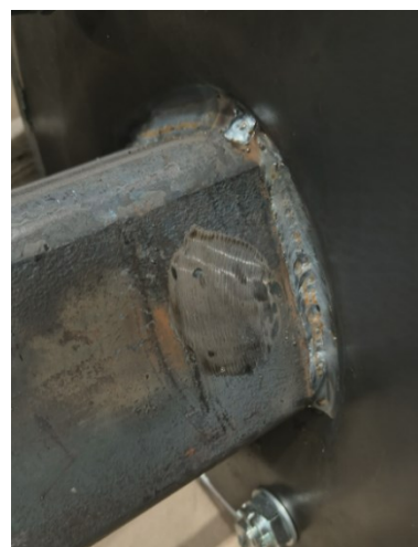
Obrázek 18: Detail děrového svaru
