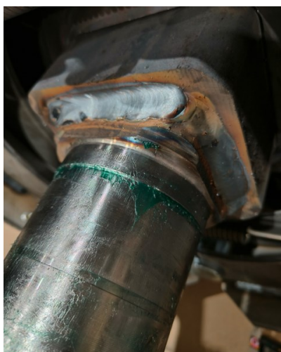
Obrázek 17: Detail přechodu čepu a ocelového profilu
