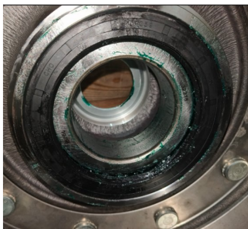
Obrázek 15: Uložení ložiska SKF 32218 v polonápravě
