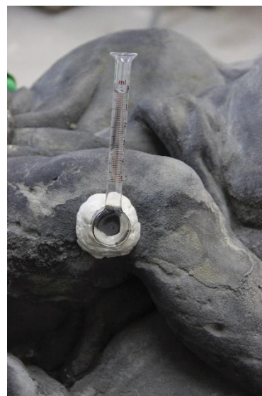
Obr. č. 8 - Ilustr. detail měření nasákavosti Karstenovou trubicí
