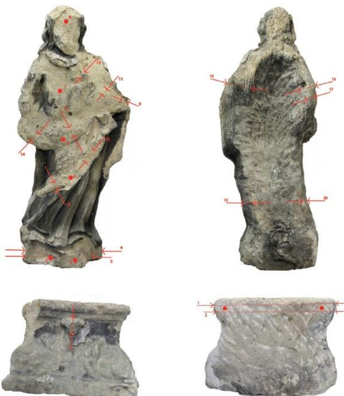
Obr. 3-6: Místa měření ultrazvukové transmise - plastika sv. Josefa s Ježíškem a podstavec. Foto a grafické zpracování: M. Glaserová.
