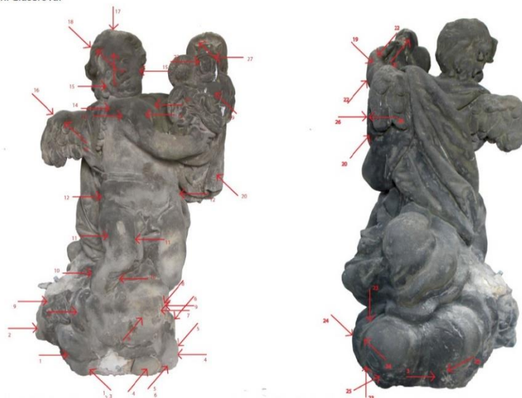
Obr. 5: Místa měření UZ transmise, putto se staroboleslavským Palladiem (po levé straně sv. Jana Nepomuckého). Foto a grafické zpracování K. Kalvodová.
