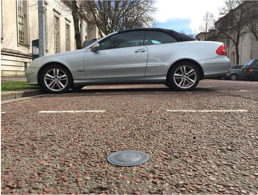
Obrázek 39 Detekující čidlo na ulici
