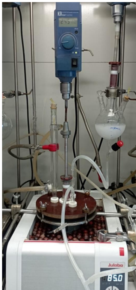
Obrázek 18: Aparatura k syntéze latexu
