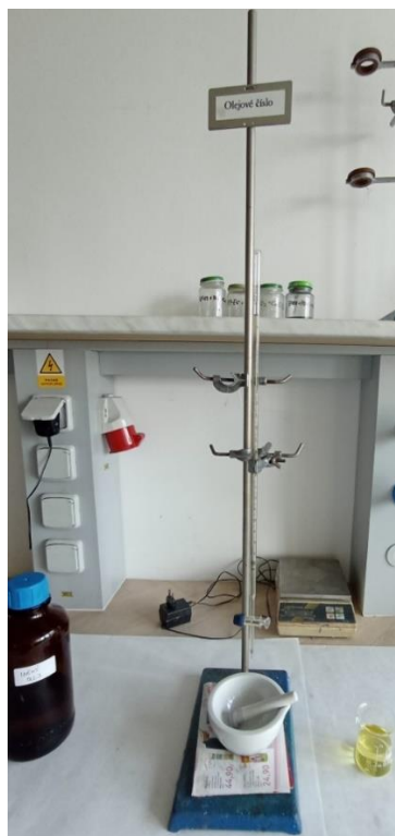
Obrázek 20: Aparatura pro stanovení olejového čísla
