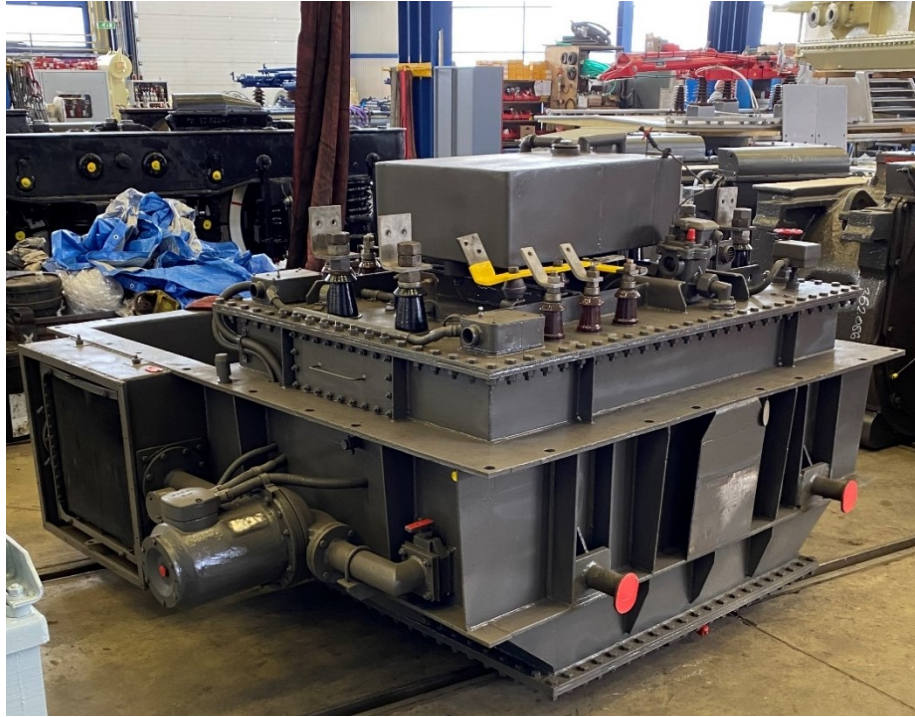
Obr. 17 Transformátorová skříň lokomotivy řady 363.
