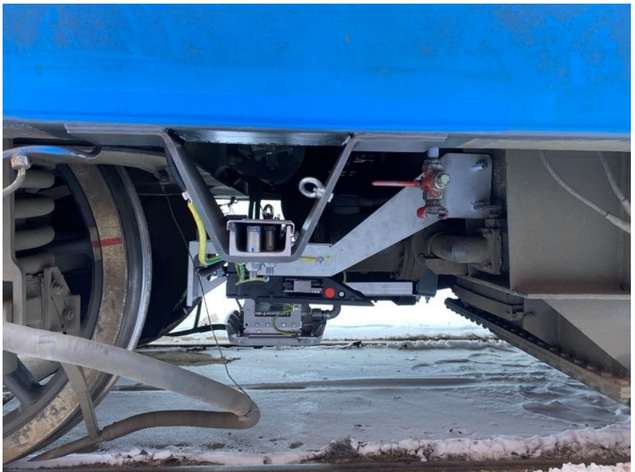
Obr. 24 Boční pohled na nosnou konstrukci instalovanou na lokomotivě řady 363.
