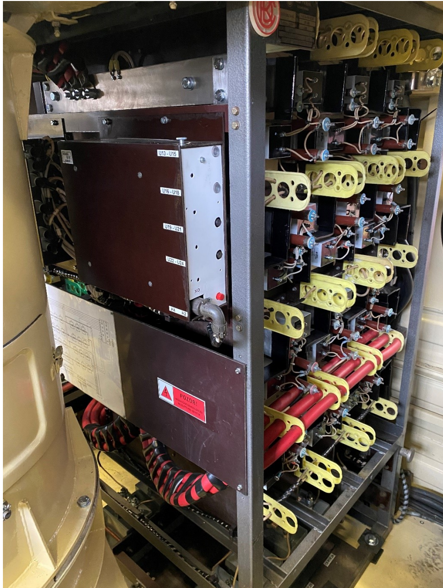
Obr. 19 Usměrňovač DIUS Delta A ve strojovně lokomotivy 363.
