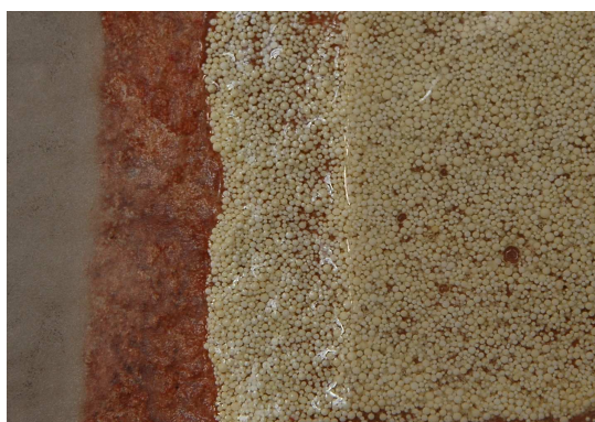
Obr.22 Postup při aplikaci iontoměniče A 830
