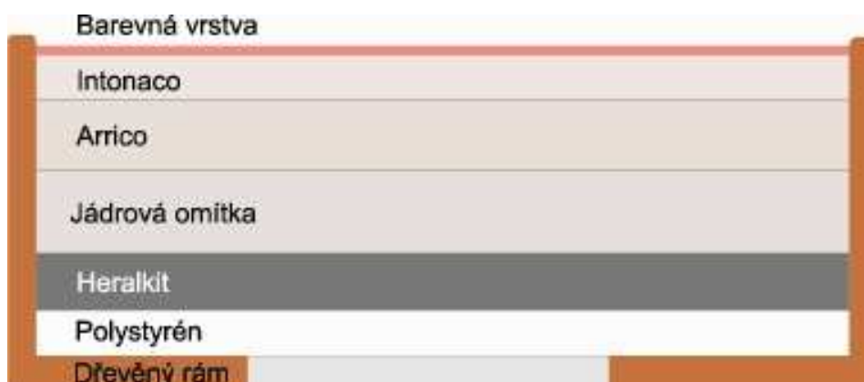
Obr.15. Skladba vrstev na připraveném panelu
