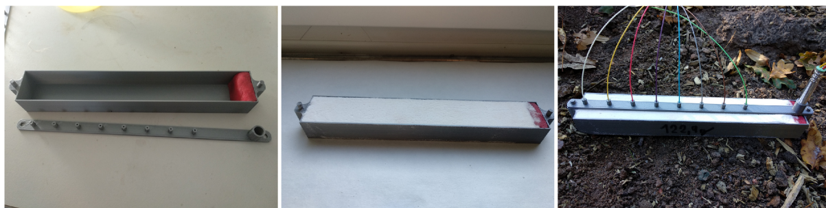
Obrázek 5.1: Sestava pro měření detonační rychlosti Semtexu S25
