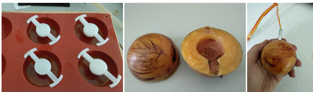
Obrázek 4.1: Odlévání polokulových náloží TNT s dutinou ve středu.
