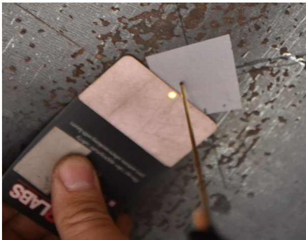
Obrázek 5.33: Detail namíření laseru a umístění piezoelektrického čidla.
