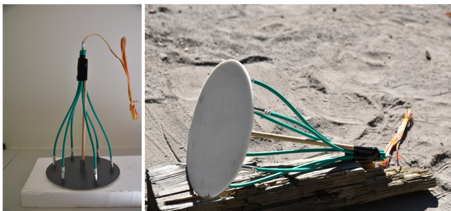
Obrázek 5.8: Fotografie sestavy ke sledování interakce detonačních vln.
