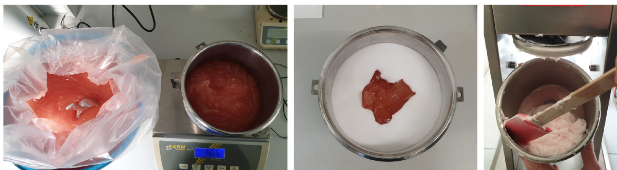
Obrázek 4.2: Příprava emulzní trhaviny. Navažování matrice nalevo, přídatek mikrokuliček uprostřed a připravená emulzní trhavina napravo.
