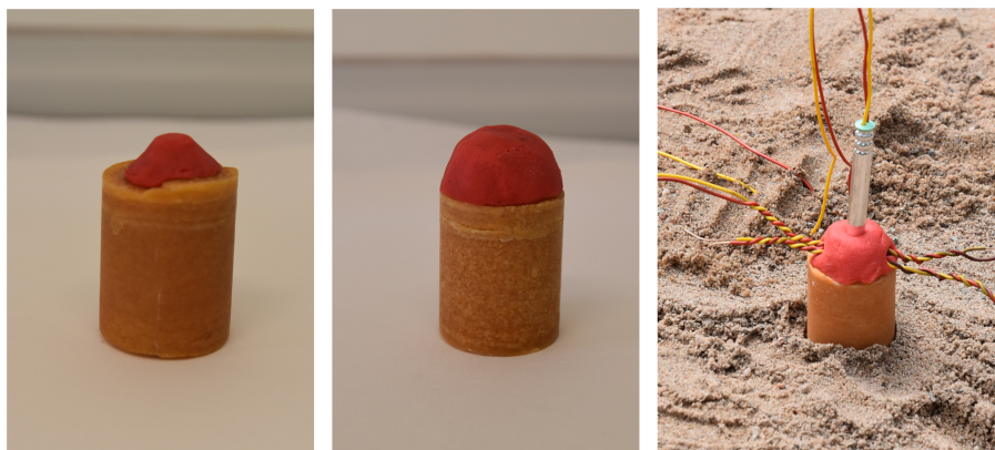
Obrázek 5.9: Fotografie litých náloží TNT s různou velikostí počínové nálože.
