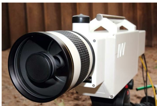
Obrázek 4.4: Vysokorychlostní kamera IVV UHSi 12/14 s objektivem Samyang 800 mm [9].
