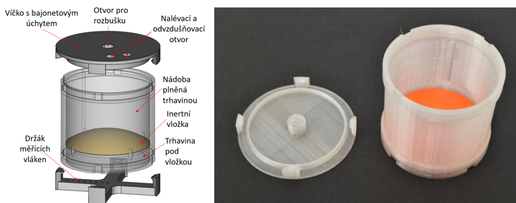
Obrázek 5.10: Generátor rovinného čela detonační vlny s inertní vložkou.
