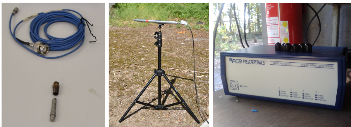
Obrázek 4.8: Tlakové senzory Kistler 211B3 (nalevo) a PCB 113B22 (uprostřed) se zesilovačem PCB ICP 482A22 (napravo).
