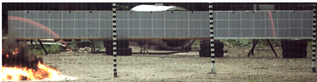
Obrázek 5.21: Vizualizace VRV po zpracování obrazu metodou odečtu snímků a následném sloučení s původním záznamem.
