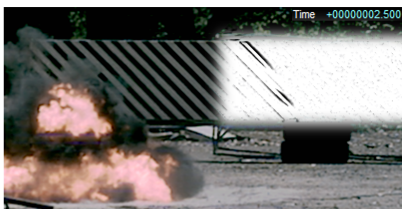
Obrázek 7.13: Vizualizace VRV na pruhovaném pozadí. Nálož 125 g TNT s 22 gramy Semtexu 1A, 5000 FPS.
