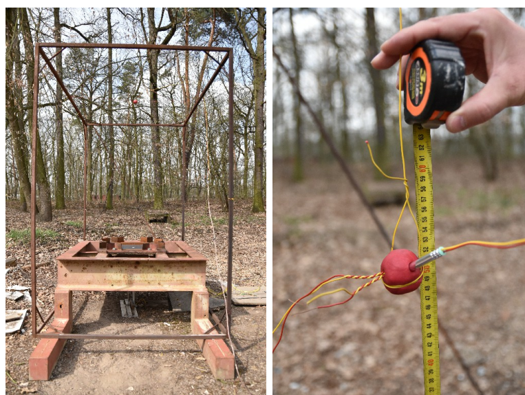
Obrázek 5.32: Fotografie uspořádání experimentu pro měření průhybu ocelové desky.
