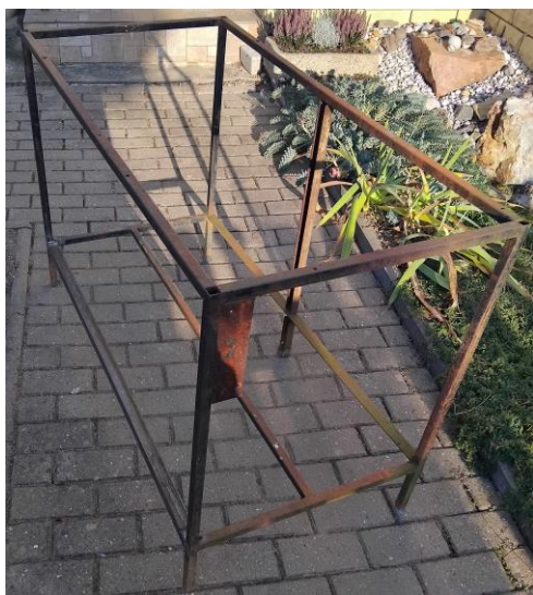
Obrázek 21: Skelet rámu (část A před úpravou a nátěrem proti korozi, část B po úpravě a nátěru proti korozi)
