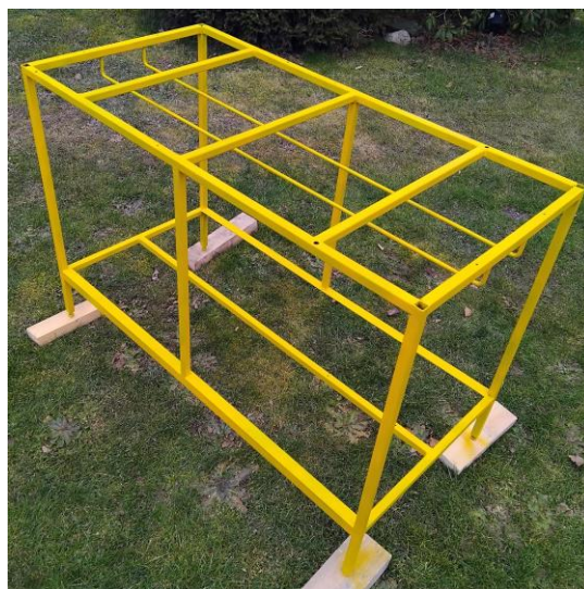
Obrázek 21: Skelet rámu (část A před úpravou a nátěrem proti korozi, část B po úpravě a nátěru proti korozi)
