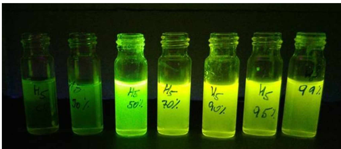
Obrázek P 4: Roztok sloučeniny XIIIc, konc. 0,1 mM ve směsi DMF/voda, zleva rostoucí objemové množství H 2 O: 0 %, 30 %, 50 %, 70 %, 90 %, 95 %, 99 %.
