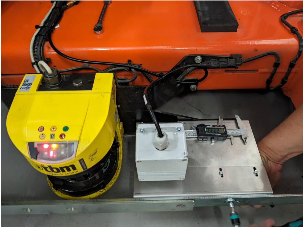
Obr. 34 Příklad umístění přední UWB antény na VNA (zdroj autor)
