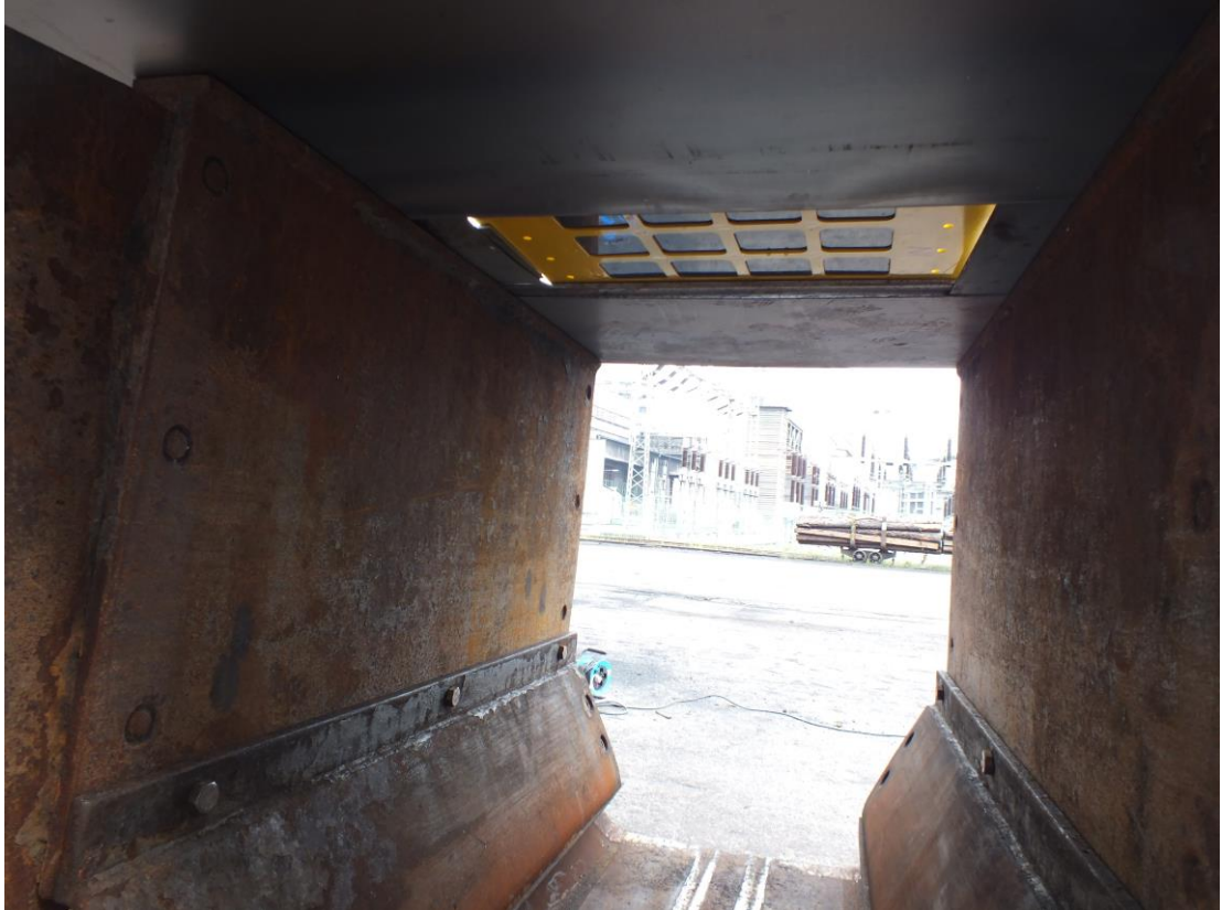
Obr. 17 Experiment s multianténním systémem pro detekci přítomnosti osoby na hřeblovém dopravníku – umístění na povrchu, test kovového stínění (zdroj autor)
