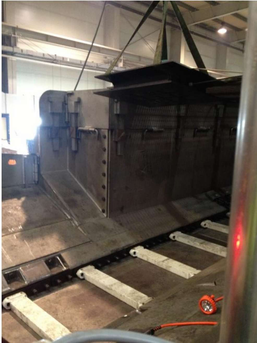
Obr. 16 Experiment s multianténním systémem pro detekci přítomnosti osoby na hřeblovém dopravníku – umístění na povrchu (zdroj autor)
