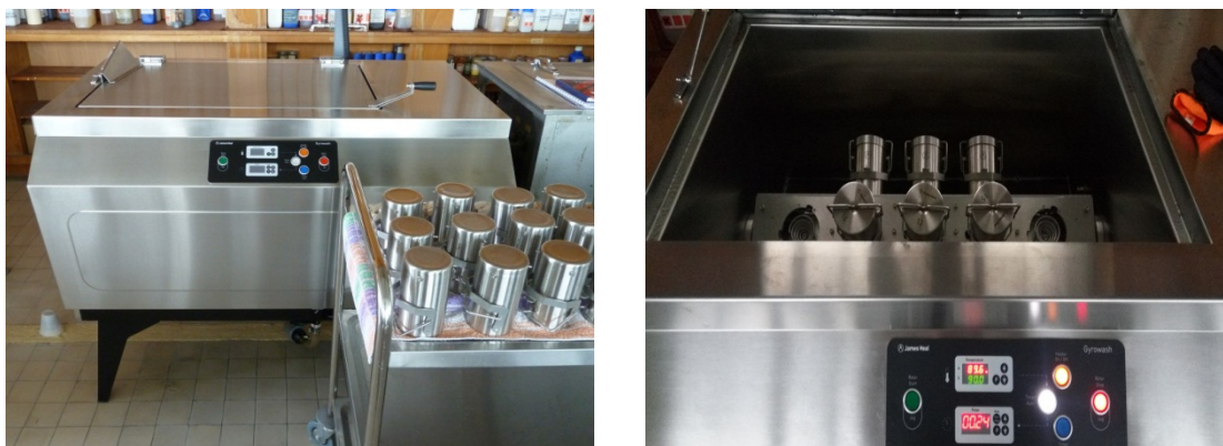
Obrázok 7. Prístroj Gyrowash, na ktorom sa testované vzorky prali. [20]
