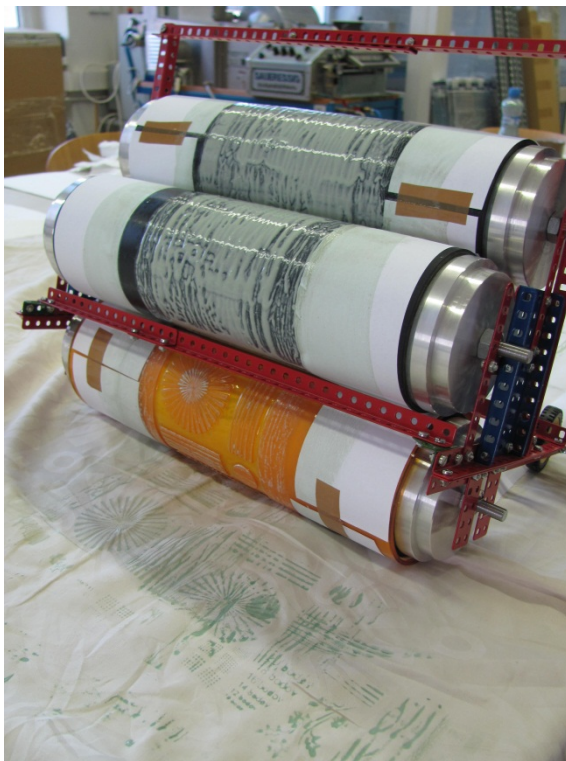
Obrázok 17. Konštrukcia zo stavebnice Merkur, ktorá bola použitá pri rotačnom nanášaní rezervy.
