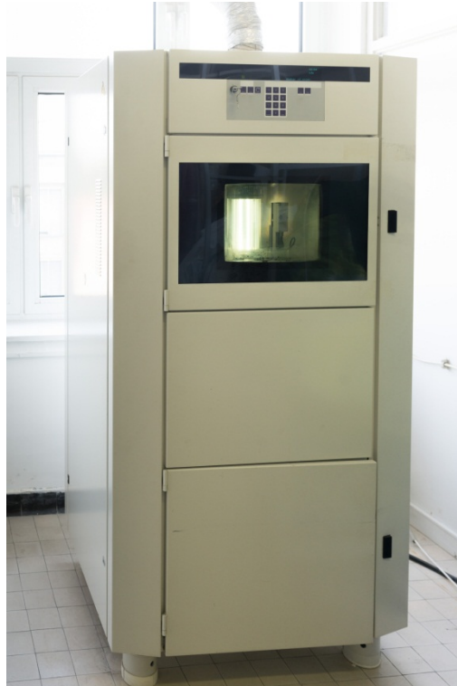
Obrázok 11. Xenotest Alpha, na ktorom sa simulovala svetlostílosť vzoriek.
