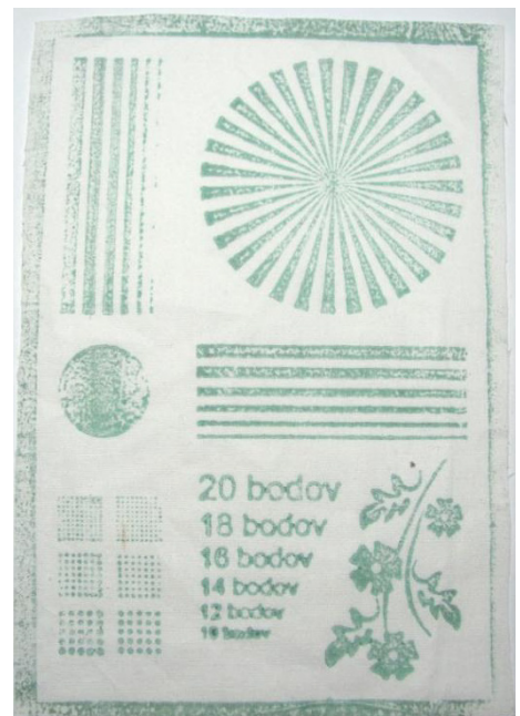
Obrázok 16. Forma vytvorená na nanášanie rezervy pečiatkovaním (vľavo). Ukážka tlače pečiatkovaním (vpravo).
