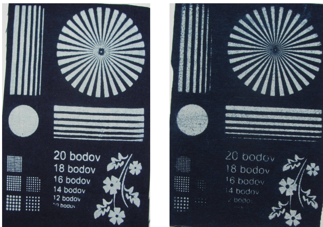
Obrázok 22. Testovací obrazec nanosený sieťotlačou o hustote 34 nití na cm. Vľavo zmesová látka 95/5 a vpravo bavlnená látka z obchodu.
