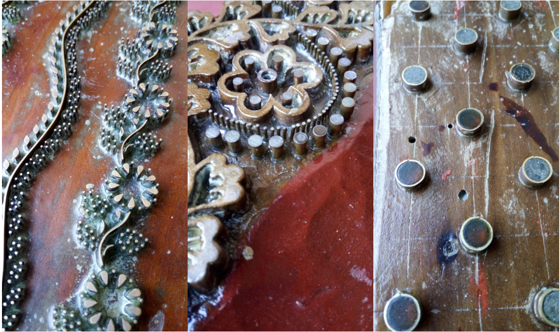
Obrázok 2. Ukážka kovovej (vľavo), kombinovanej formy(v strede), a kovovej formy (vpravo), ktorá má plochy medzi plieškami vyplnené smolnou hmotou.
