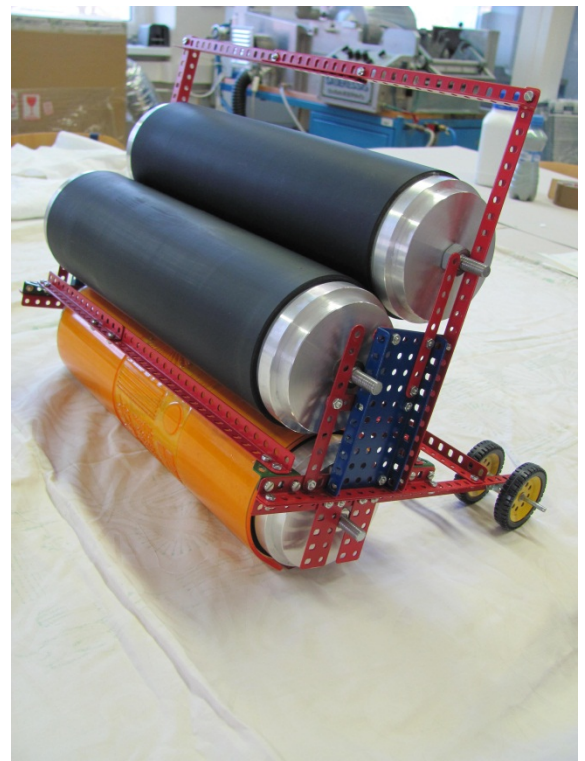
Obrázok 17. Konštrukcia zo stavebnice Merkur, ktorá bola použitá pri rotačnom nanášaní rezervy.
