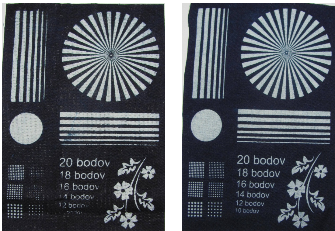
Obrázok 23. Testovací obrazec nanosený sieťotlačou o hustote 43 nití na cm. Vľavo bavlnené plátno z modrotlačovej dielne a vpravo bavlnená látka z obchodu.
