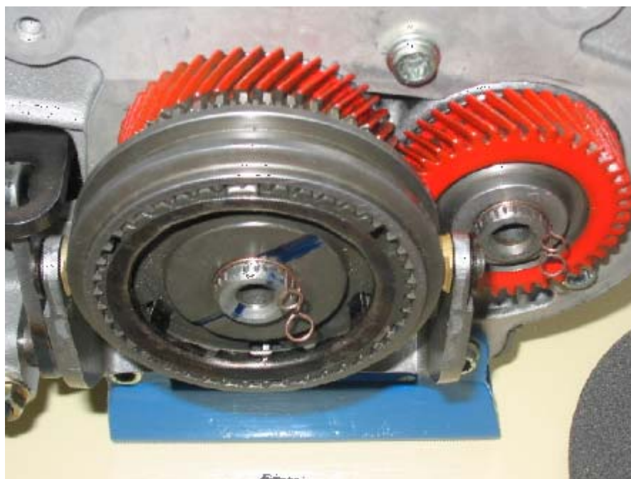
Obr. 9.5 Detail odnímatelné synchronizační spojky V. rychlostního stupně
