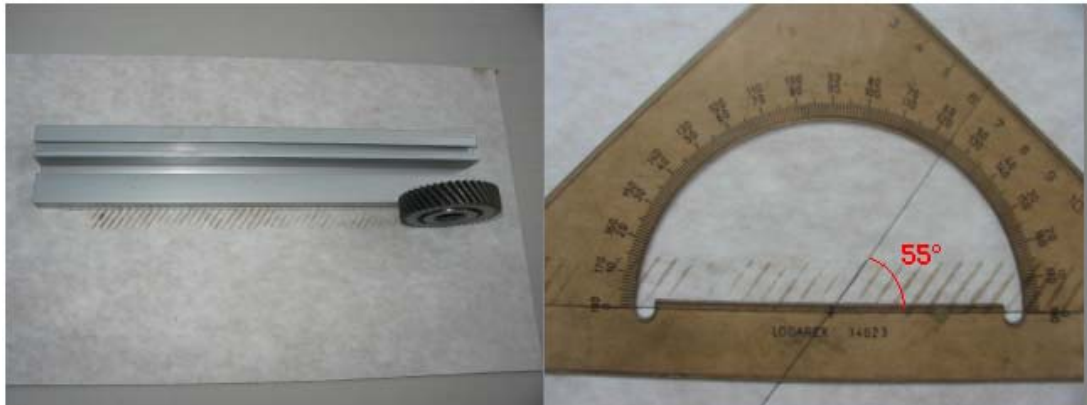
Obr. 4.1 Orientační měření úhlu sklonu zubů
