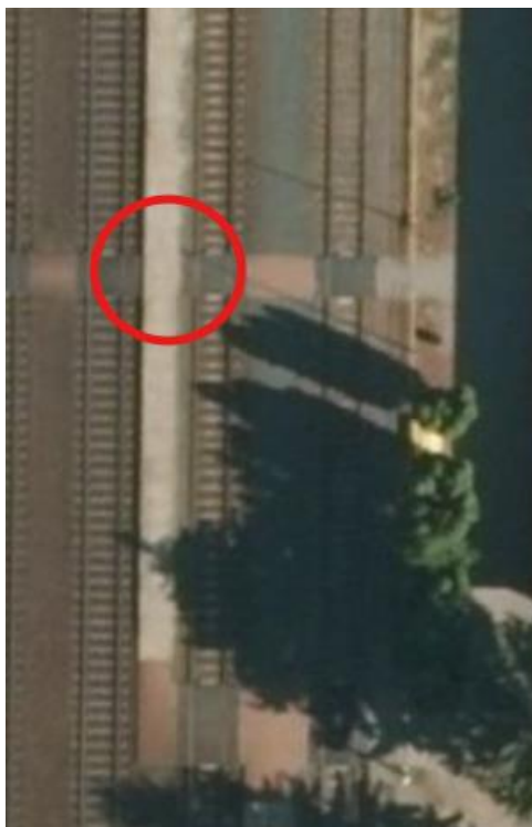
Obrázek 38 Vyznačení snížení železničního nástupiště ve stanici Modřice
