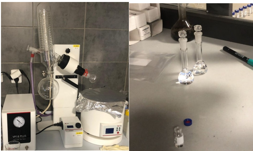
Obrázek 6 Fotografie rotační vakuové odparky (vlevo) a extrakční standardy Acenaften-D10 a Benz[a]antracene-D12 a vialka se vzorkem (vpravo), vlastní fotografie.
