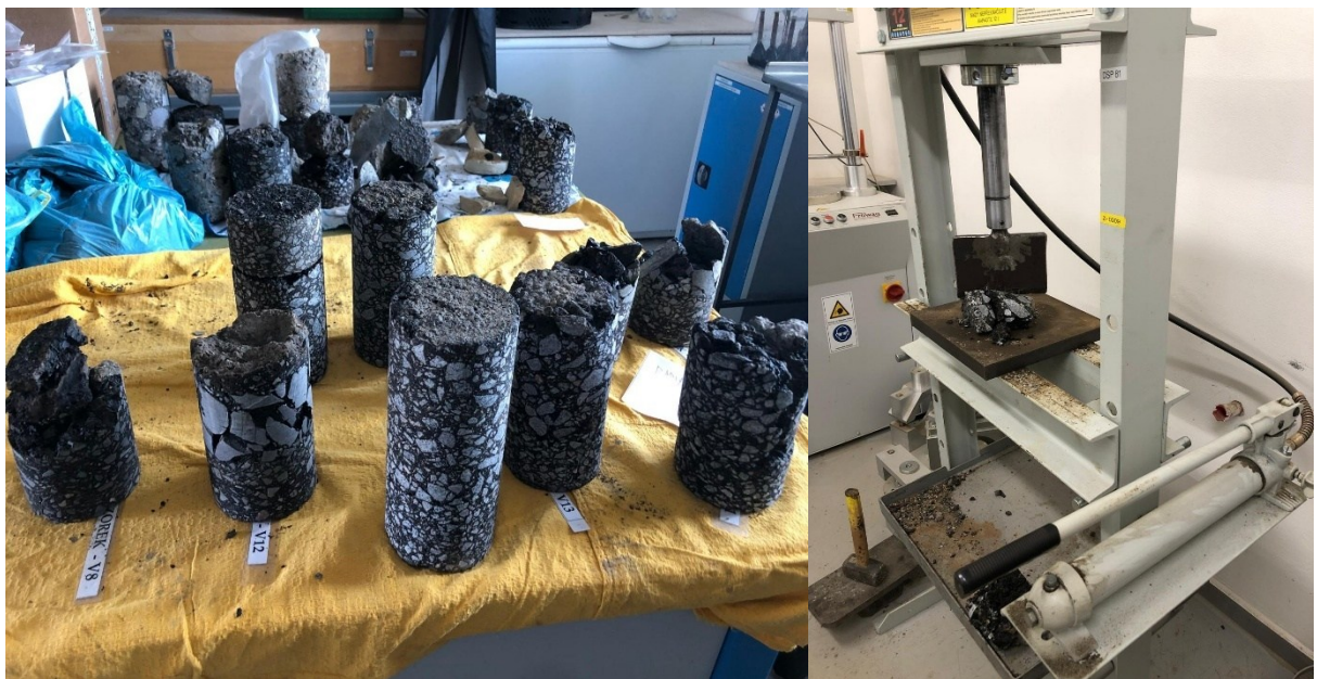
Obrázek 4 Fotografie sušení jádrového vývrtu (vlevo) a drcení vzorku pomocí hydraulického lisu (vpravo), vlastní fotografie
