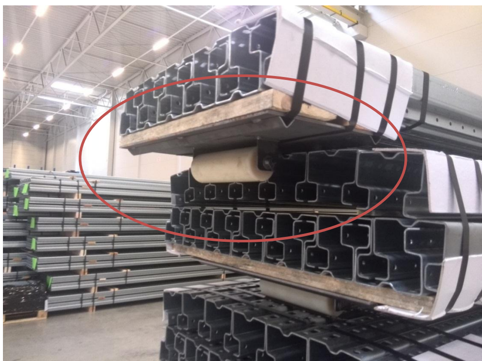
Obr. 6 Manipulační podvozek dlouhého materiálu
