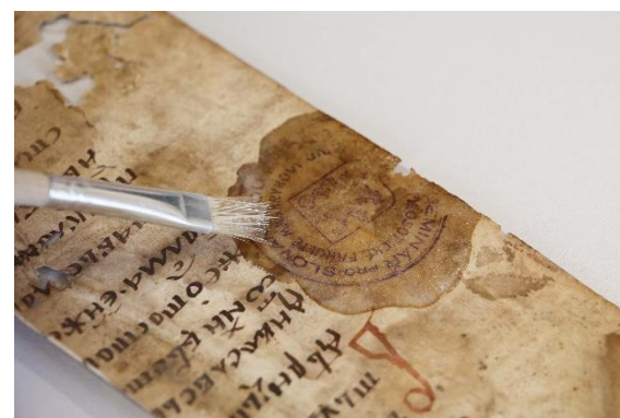
Obrázek 89 Dočasná fixace razítka taveninou cyklododekanu před mokrým čištěním
