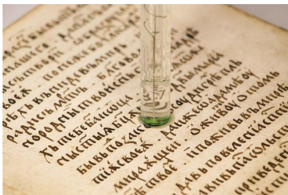
Obrázek 86 Měření pH papírové podložky
