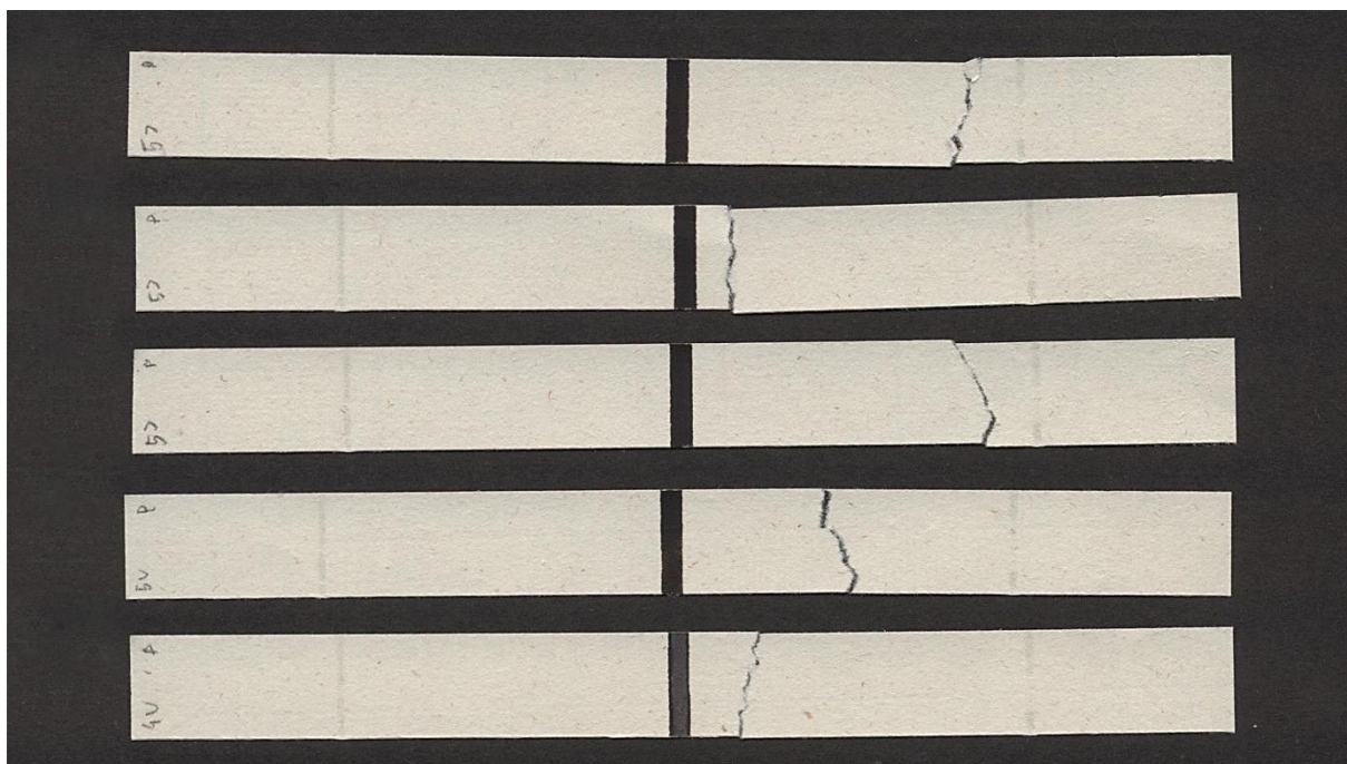
Obrázek 53 Vzorky po zkouškách tržného zatížení
