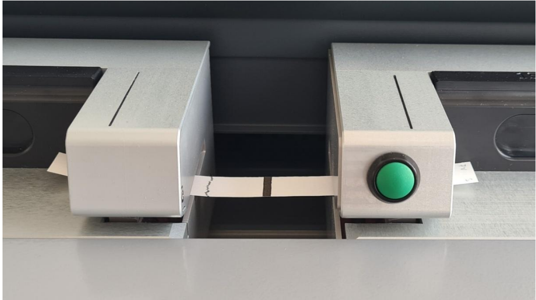
Obrázek 49 Pohled na vzorek uchycený v klemách přístroje L&W Alwetron TH1
