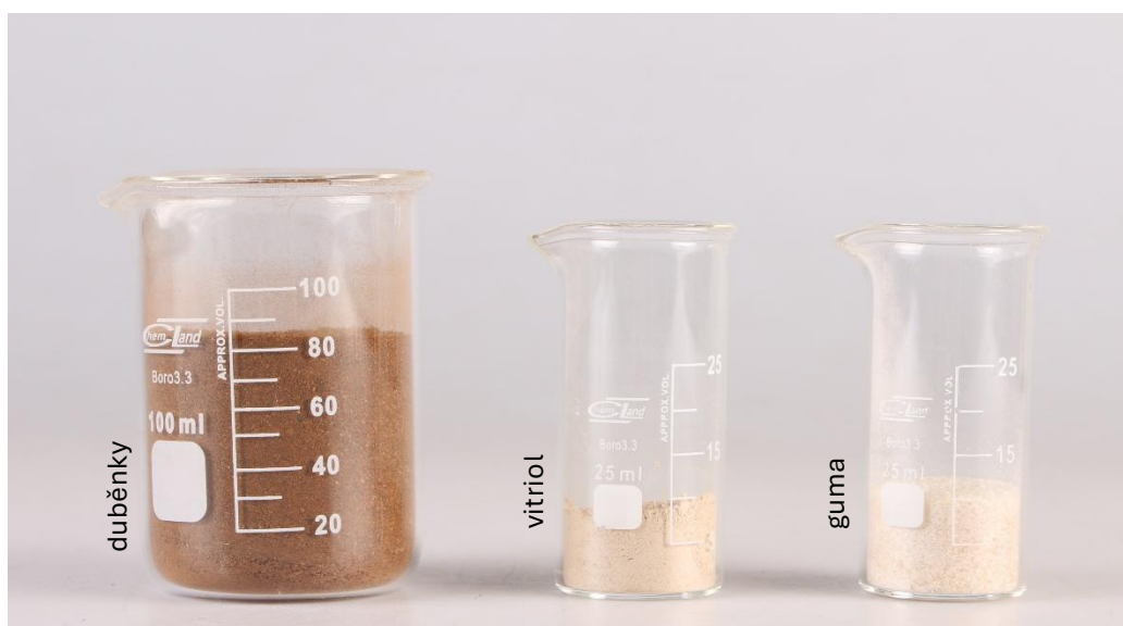
Obrázek 16 Příprava Inkoustu 3 (víno) a Inkoustu 4 (víno+var) – znázornění množství surovin
