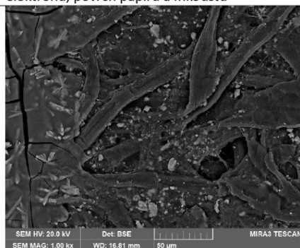
SEM-BSE, foto v režimu zpětně odražených elektronů, povrch papíru a okraj inkoustu s drobnými krystaly (CaSO 4 ·2H 2 O), světlá zrna v papíru jsou částice CaCO 3
