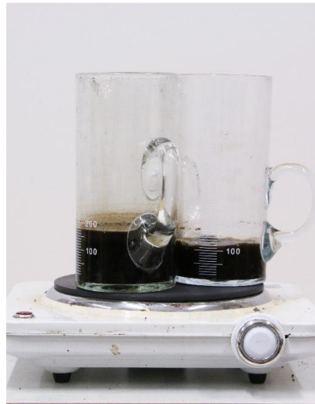
Obrázek 21 Příprava Inkoustu 5 (pevný) – míchání
