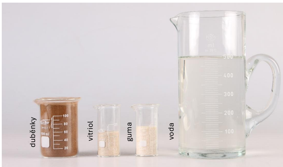
Obrázek 12 Příprava Inkoustu 1 (voda) a Inkoustu 2 (voda+var) – znázornění množství surovin
