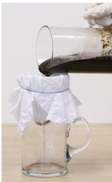
Obrázek 29 Příprava Inkoustu 7 (voda+ocet) – filtrace
