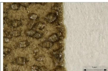
Mikrofoto, stereomikroskop, dopadající bílé světlo, povrch papíru a inkoustu s viditelnými krystaly
