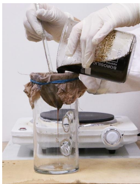
Obrázek 18 Příprava Inkoustu 5 (pevný) – slítí extraktu 45
