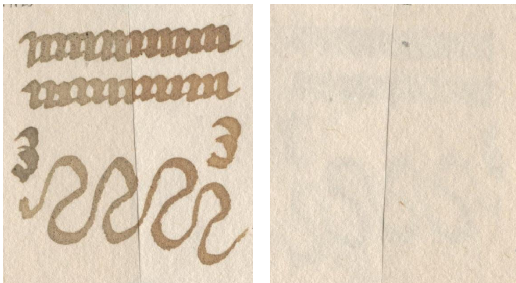
Obrázek 33 Předběžný vzorek Inkoustu 3 (víno) z 2.1.2025 – vlevo líc (pravá část vzorku vystavená slunci), vpravo rub (levá část vzorku vystavená slunci)
