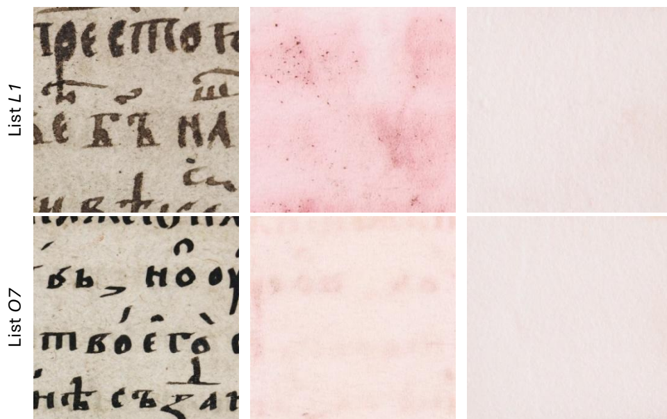
Obrázek 85 Ukázky bathofenantrolinového test, zleva: testované místo, indikační filtrační papírek před zásahem a po zásahu
