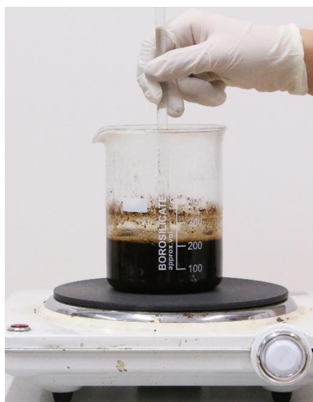
Obrázek 17 Příprava Inkoustu 5 (pevný) – vaření
