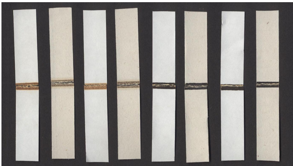
Obrázek 56 Vzorky po zkouškách odolnosti v přehýbání
