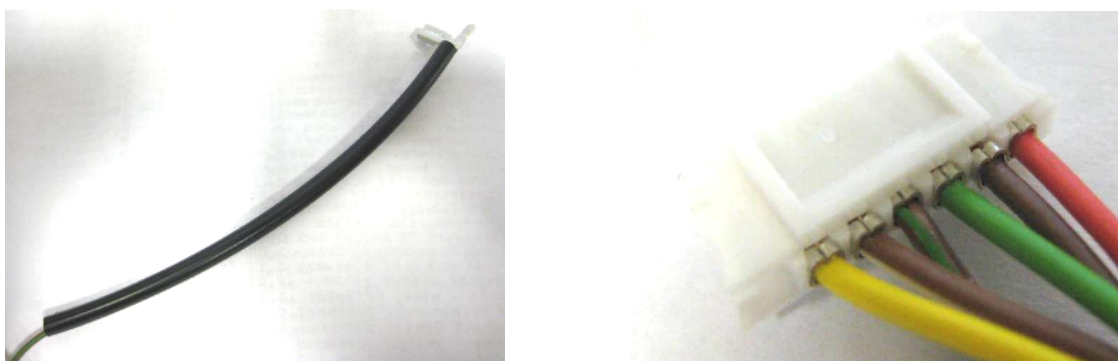
Obr. 19 - Vložení vodiče do trubičky, vložení vodičů do pouzdra
