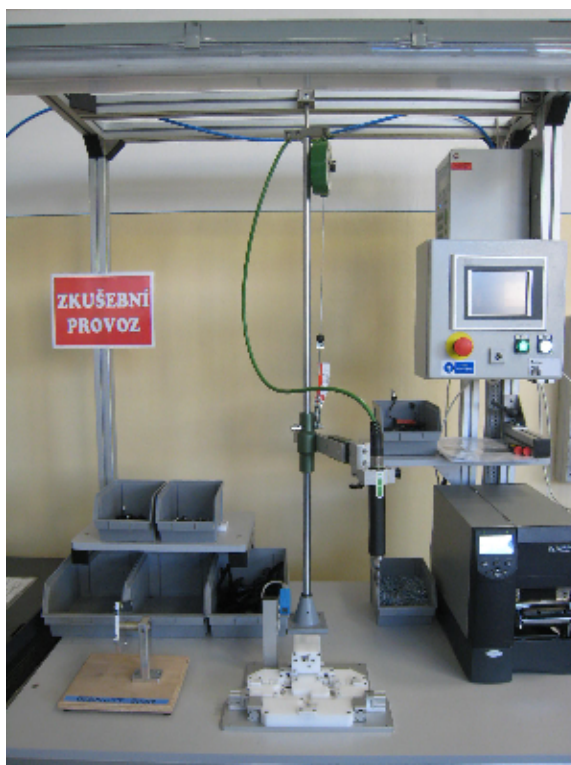
Obr. 17 - Tester ECU jednotky McLaren
