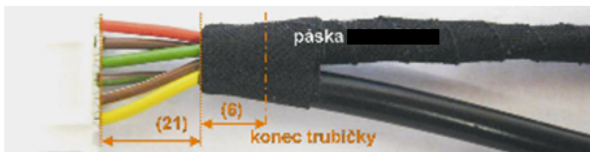
Obr. 20 - Omotání a správné umístění trubičky
