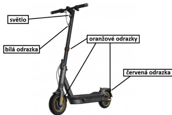
Obrázek 2: Povinná výbava koloběžky na elektrický pohon
