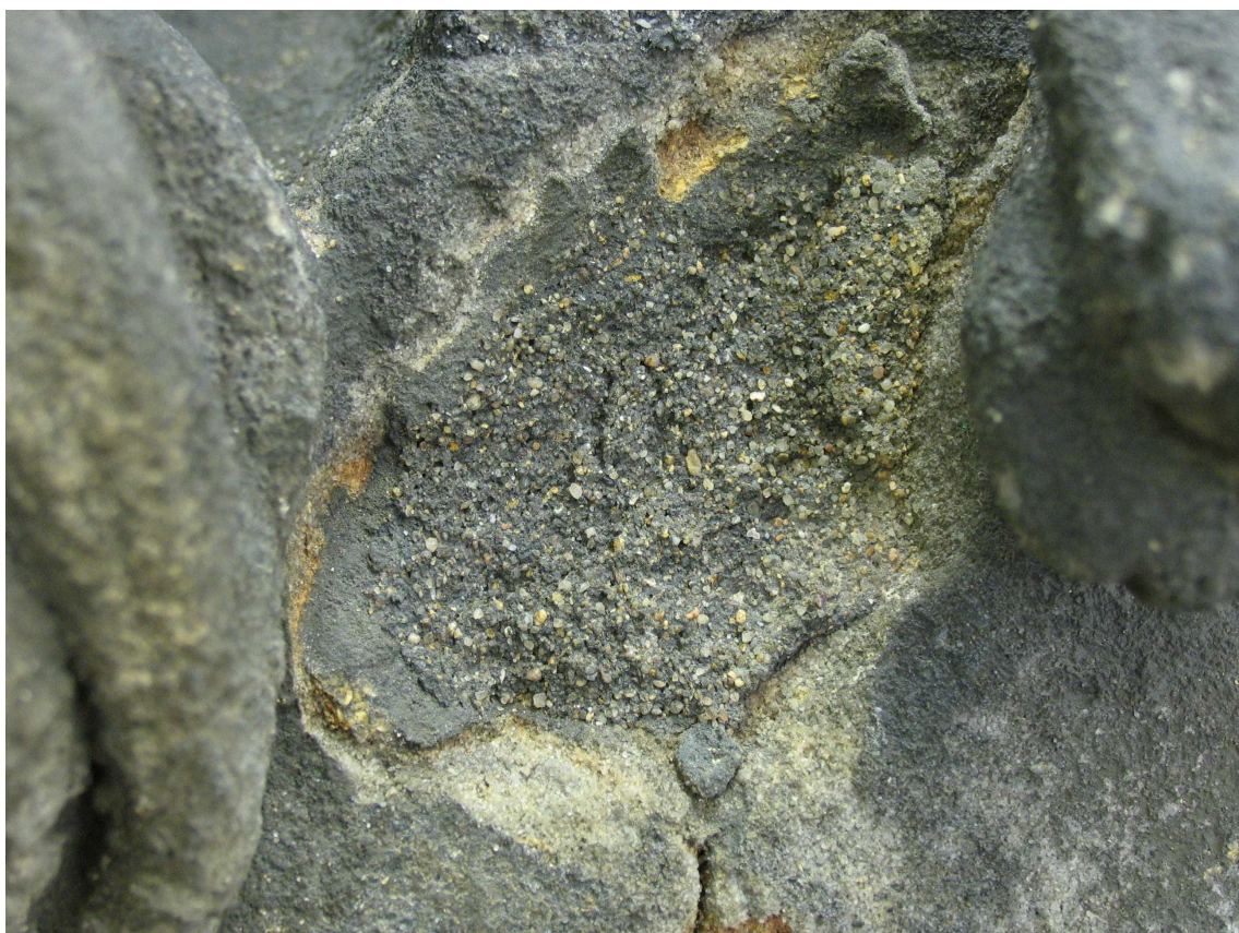
Obr.20 - 2. typ staršieho tmelu
