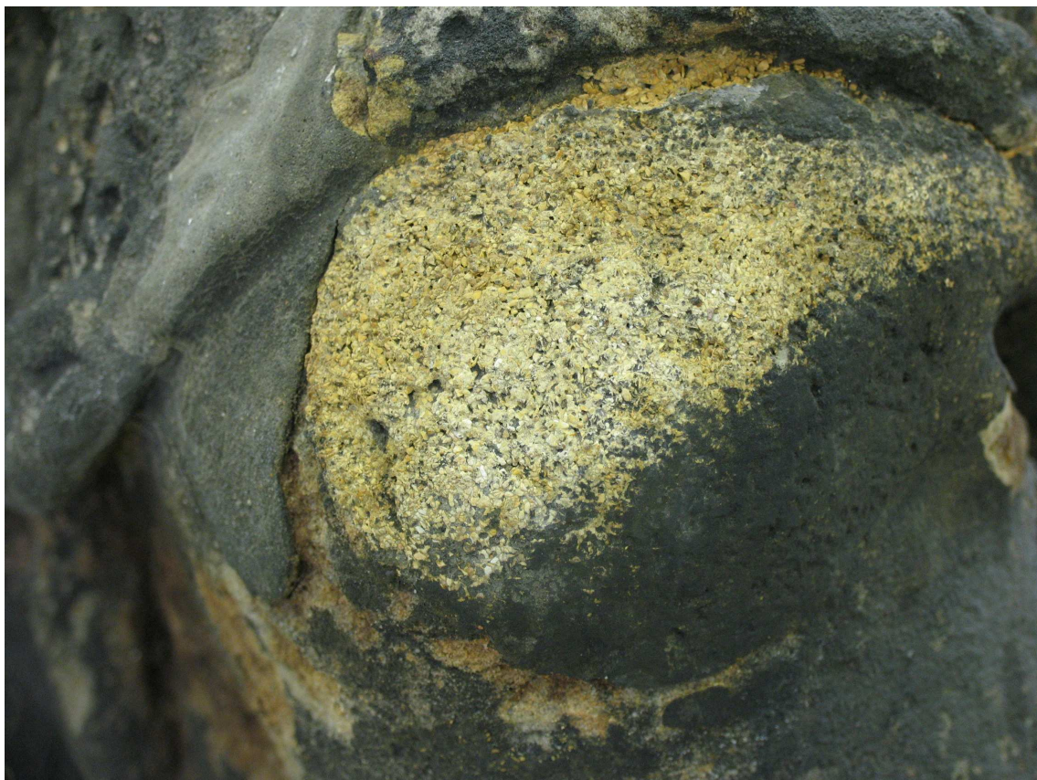
Obr.21 - 3. typ staršího tmelu
