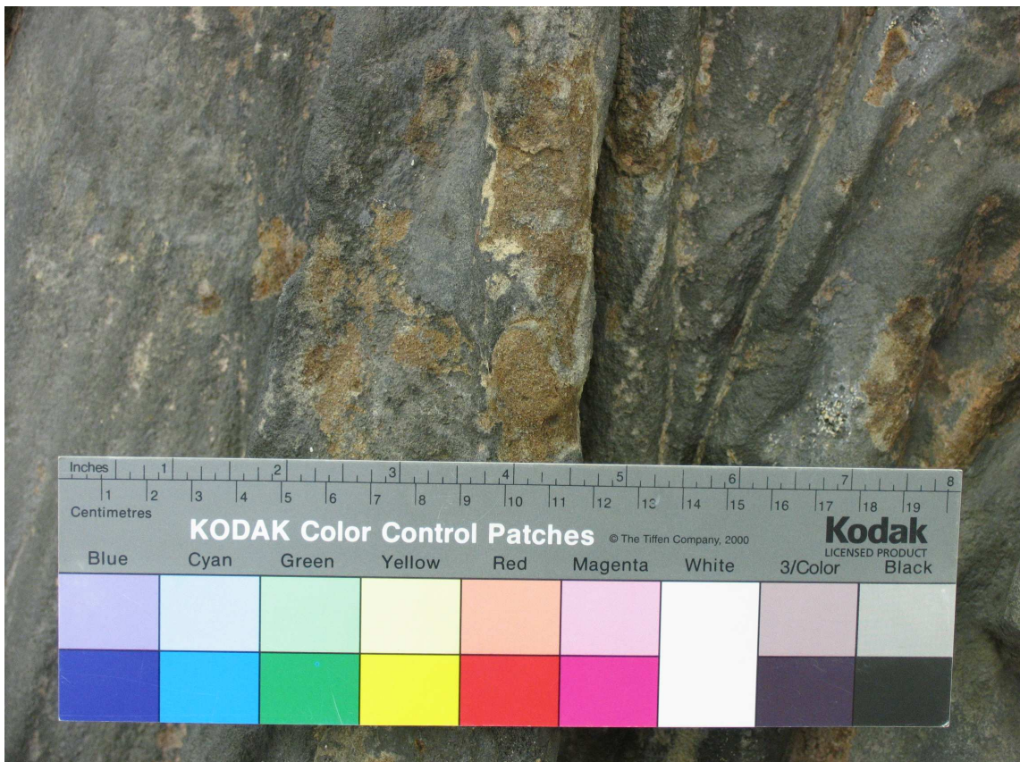
Obr.63 - zbytky vysych. olejů
