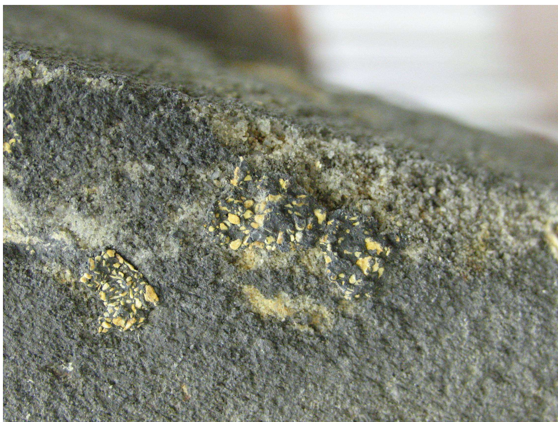
Obr.24 - 6. typ staršího tmelu
