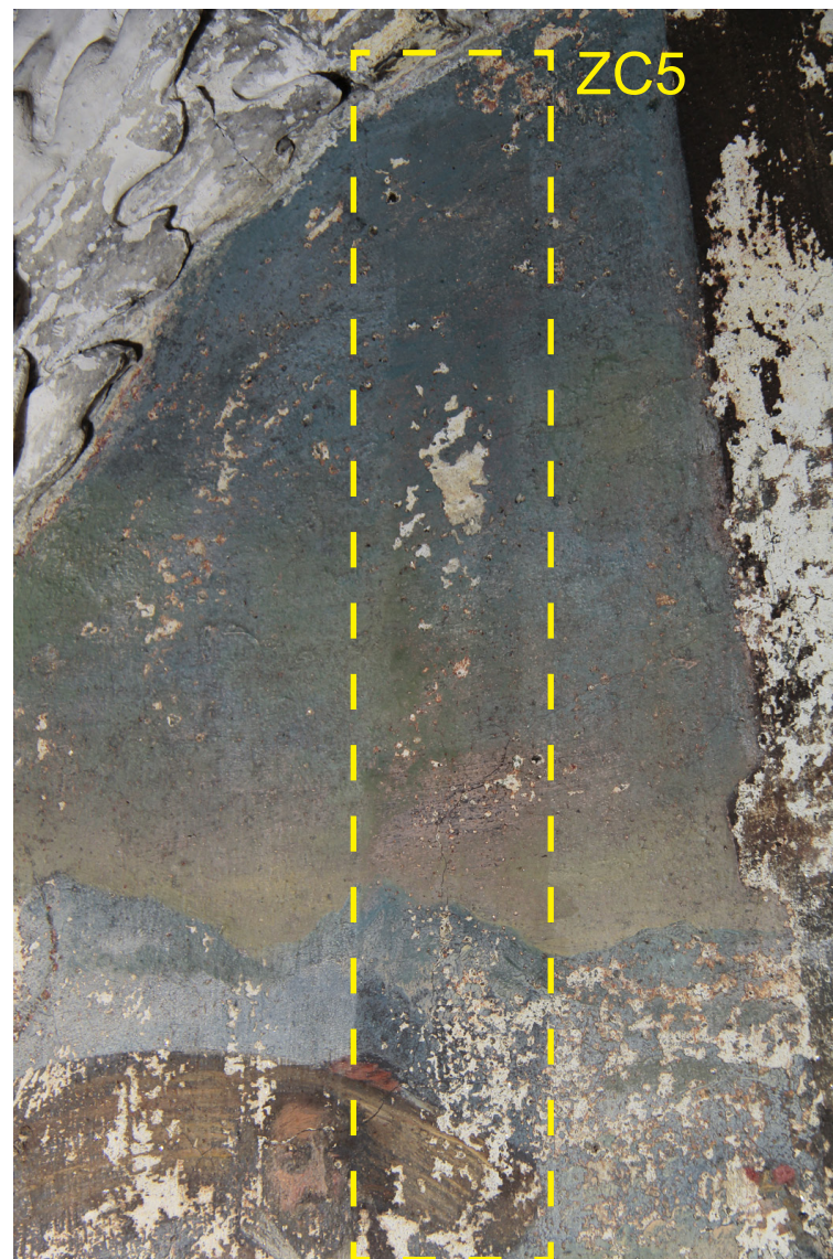
Obr.36: Výjev na klenbě. Zkoušky čištění a snímání přemaleb. ZC5: čištění cca 5% (hm.) roztokem citátu amonného ve vodě.
