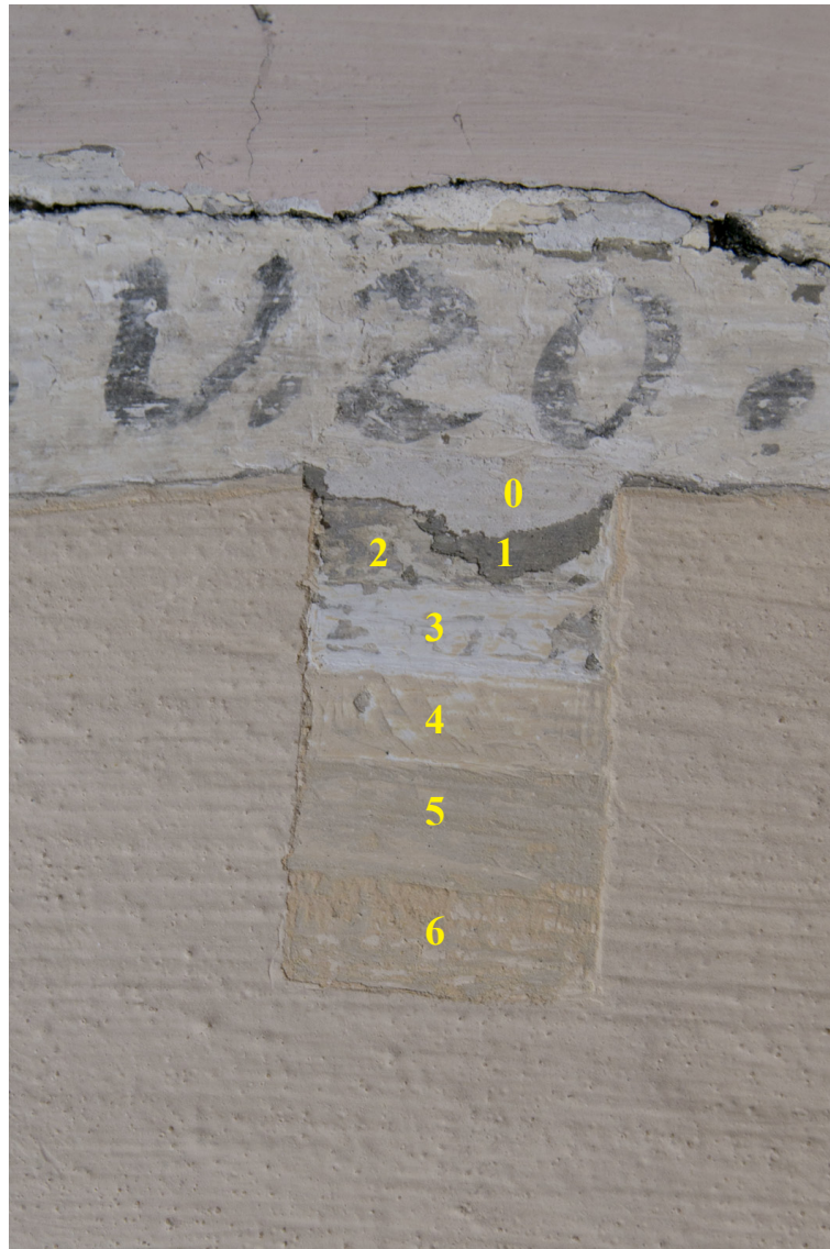
Obr. 25: Sondážní průzkum. Stratigrafická sonda S3 na stěně stěně pod středovou partií štukového zrcadla se svatováclavským výjevem: 0) světlý podklad, vápenný nátěr (podklad písma), 1) tmavě šedý nátěr, 2) světle šedý nátěr, 3) 1–2 vrstvy bílého vápenného nátěru, 4) vrstva světlého okrově-oranžového nátěru, 5) vrstva světle šedavého nátěru (nečistoty?), 6) vrstva světlého okrově-oranžového nátěru.
