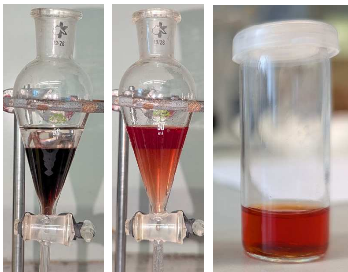
Obrázek 42. Zreagovaný roztok PPD před vytřepáním do diethyletheru a úpravou pH (vlevo), po vytřepání a úpravě pH (uprostřed) a izolovaná organická fáze pro analýzu (vpravo).
