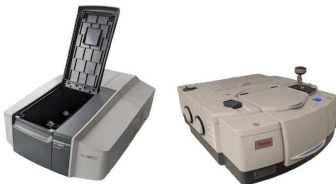
Obrázek 27. Měřící přístroj Shimadzu UV-2450 UV-Vis Spektrofotometr (vlevo) a FTIR spektrometr iS50 Nicolet (vpravo).
