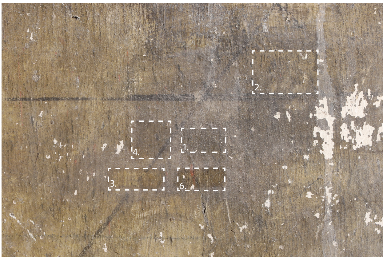
Obr. 47: Zkoušky čištění v pravé střední části jihovýchodní stěny: 3. – lakový benzín, 4. – 1% citrát amonný ve vodě, 5. – voda s detergentem Ethomeen C25 , 6. – lakový benzín s detergentem Ethomeen C12 .
