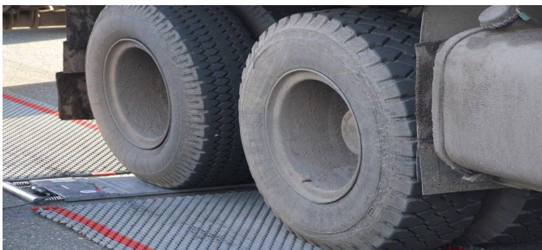
Obrázek 13 - Nápravové vážení vozidel Policií ČR
