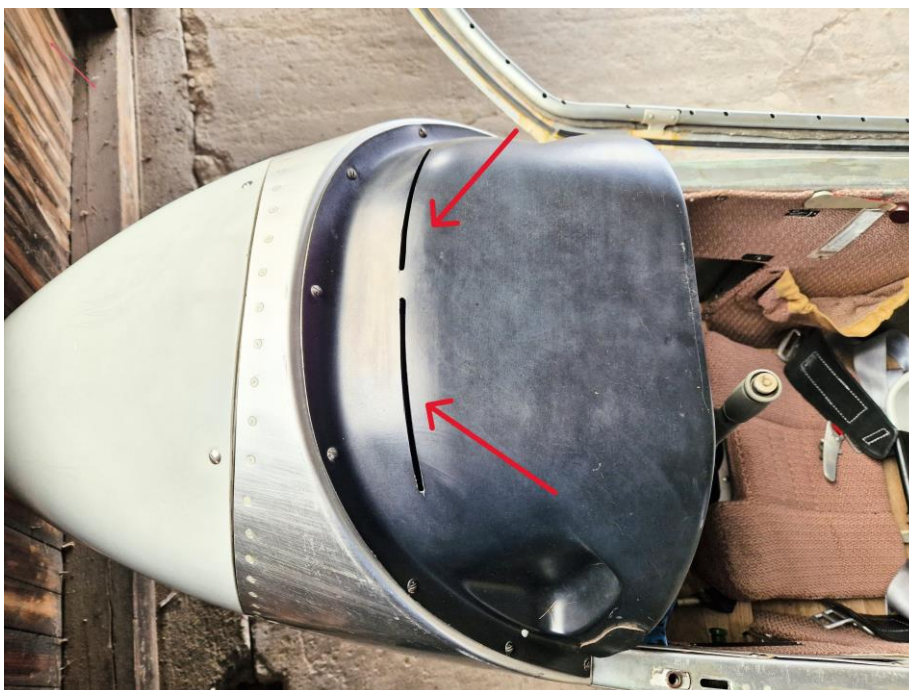
Obrázek 15: Vzduchové štěrbinové větracího systému L23 Super Blaník 32
