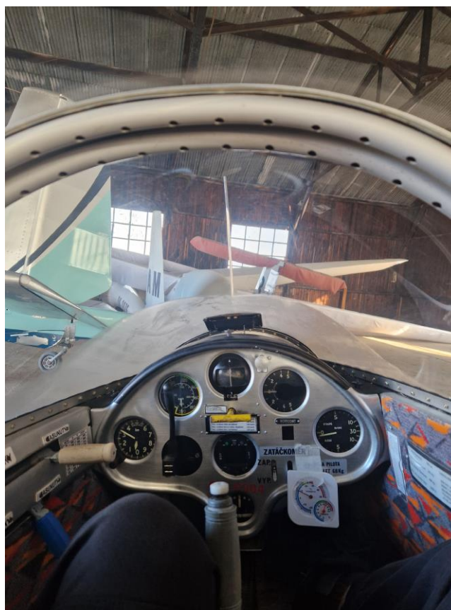
Obrázek 6: Kondenzace nad palubní deskou při použití větráku 20
