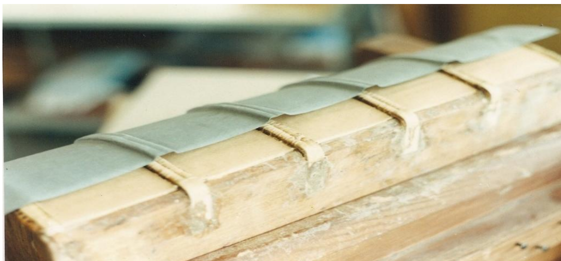
obr. 68 Formovaný chrbátnik a jeho príprava s viditeľným spracovaním šitia a medziväzných prelepov, tmelenia nasadenia dosiek (foto: Ivan Galamboš)
