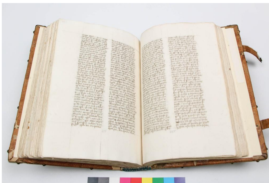
obr. 41 Rukopis bielený 1 % roztokom manganistanu draselného a 1 % roztokom pyrosiričitanu, Mns. 42 KBK SNA
