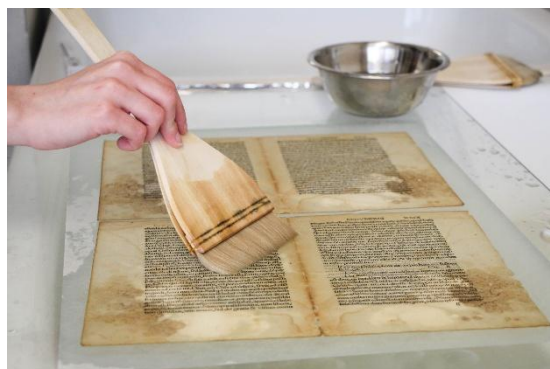
obr. 133 Doglejenie papierovej podložky roztokom Tylose HM 300
