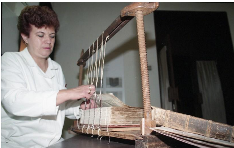
obr. 13 Reštaurátorka z UKB pri šití zreštaurovaného knižného bloku (zdroj: archív TASR)
