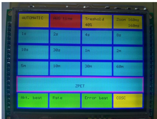
Obr. 6. 3 Nastavení doby počítání průměrných hodnot
