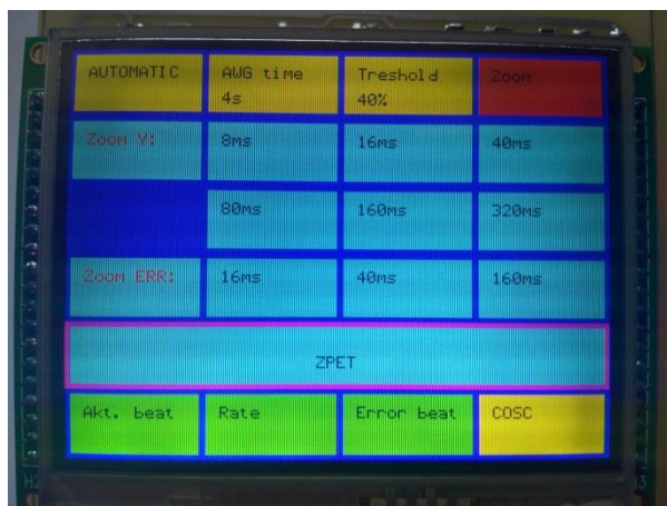
Obr. 6. 5 Nastavení rozlišení měřených odchylek
