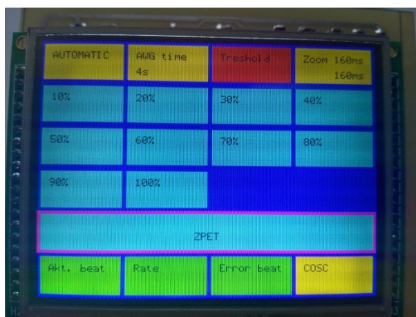
Obr. 6. 4 Nastavení detekční úrovně threshold
