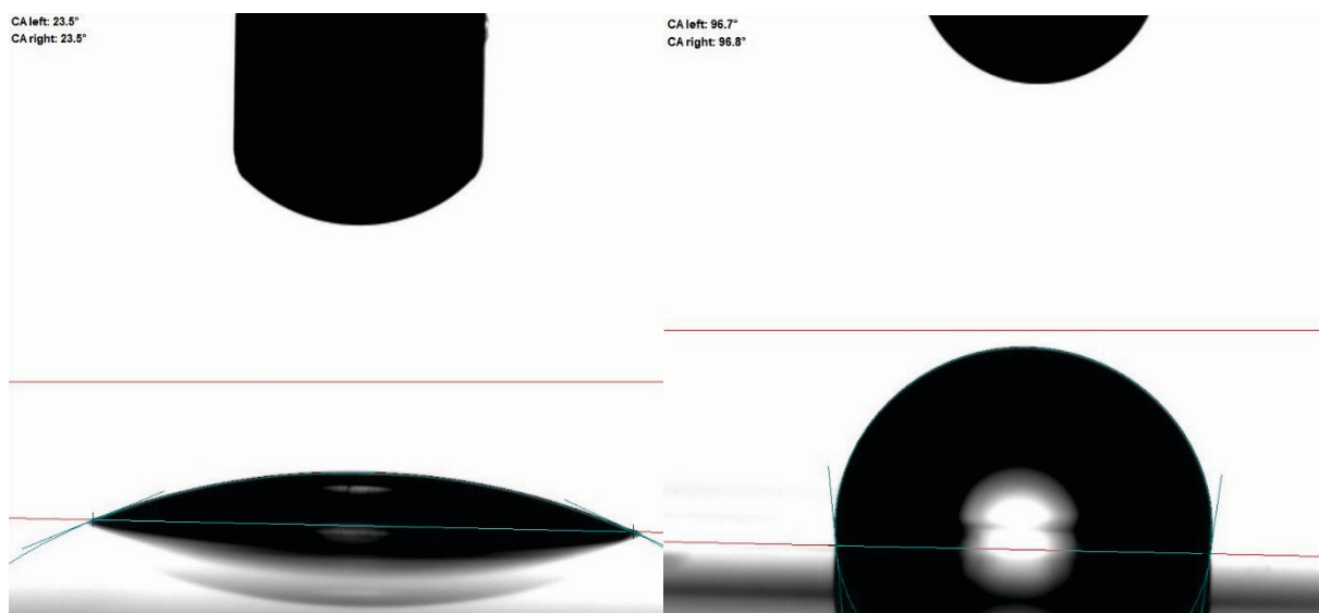
Obrázek 2: Ukázka dobrého (vlevo) a špatného (vpravo) smáčení pevné látky kapalinou
