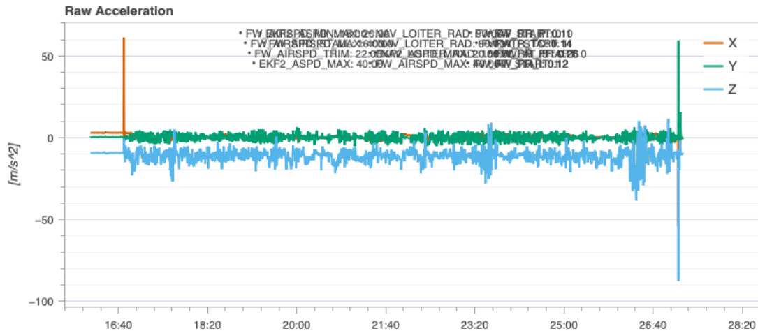
Obrázek 17: Akcelerace v jednotlivých osách autopilota letu č. 2 [16]
