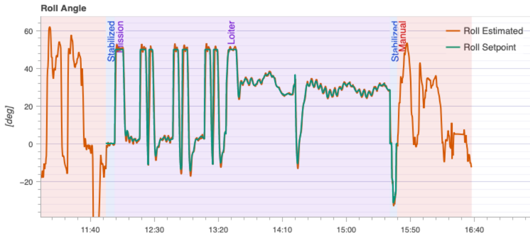
Obrázek 24: Průběh úhlu klopení v čase letu č. 3 [17]
