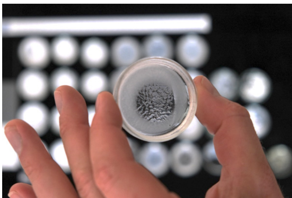
Obr. 22: Chování gelu Primer Hydro Silicatfestiger při 80% RH, zřetelná hygroskopická vytvořených solí.
