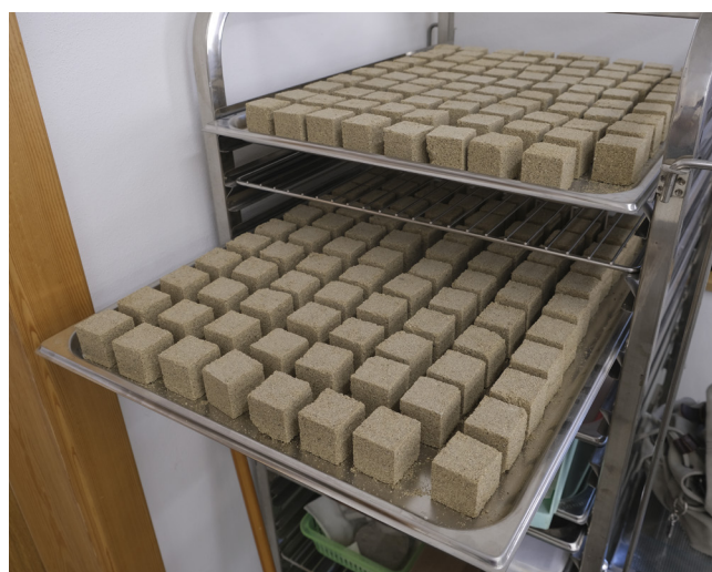
Obr. 05: Homogenní nekonsolidovaná modelová tělesa po výjmutí z forem.
