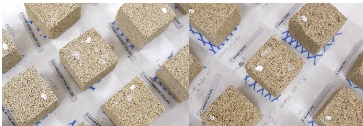
Obr. 23: Pravděpodobně solné výkvěty na povrchu tělesa napuštěného Levasilem CC301
