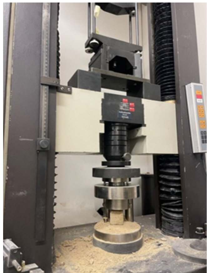
Obr. 14: Trhací stroj FPZ 100/1 s umístěným konsolidovaným tělesem připraveným k měření.
