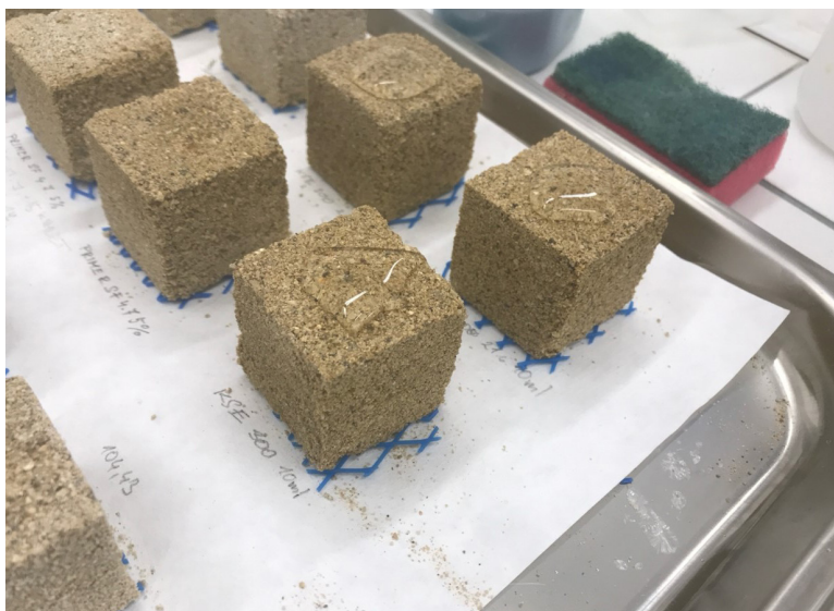
Obr. 26: „Drop test“ – hydrofobitáí povrchu konsolidovaných vzorků KSE 300, po 2 měsících v podmínkách relativní vlhkosti vzduchu \geq 60\% .
