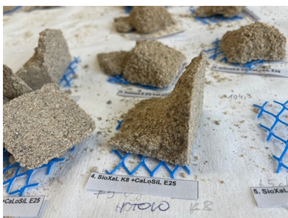
Obr. 27: Úlomky vzorků kombinace křemičitého solu + CaLoSiL E25, pozorování úlomků po pevnosti v tlaku.
