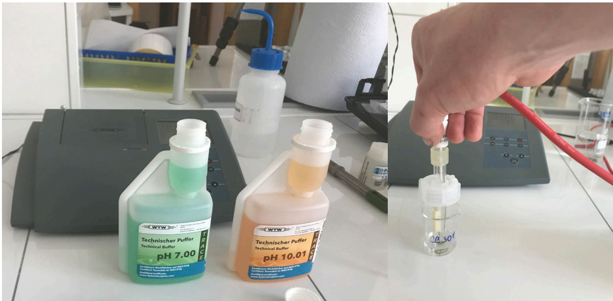
Obr. 08: Měření pH konsolidantu pomocí pH metru WTW, inoLab s kalibrací v rozmezí pH 7,00-10,01.
