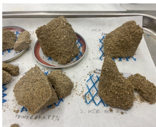
Obr. 28: Úlomky vzorků kombinace organokřemičitanu KSE300, pozorování úlomků po pevnosti v tlaku.
