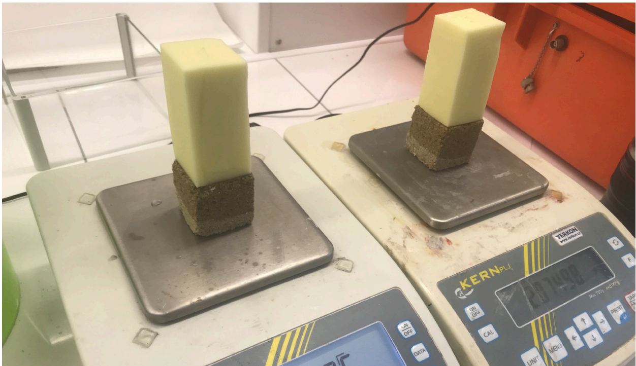
Obr. 11: Měření kapilární nasákavosti, působ aplikace houby na vzorek a průběžná kontrola na váze.
