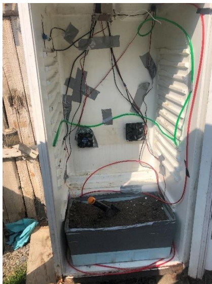
Obrázek 3.4 - Rozmístění senzorů v uzavřené soustavě
