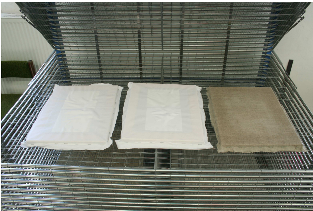
Obr. č. 13 Schnutí vzorků ve vodorovné poloze ve stabilních klimatických podmínkách.
