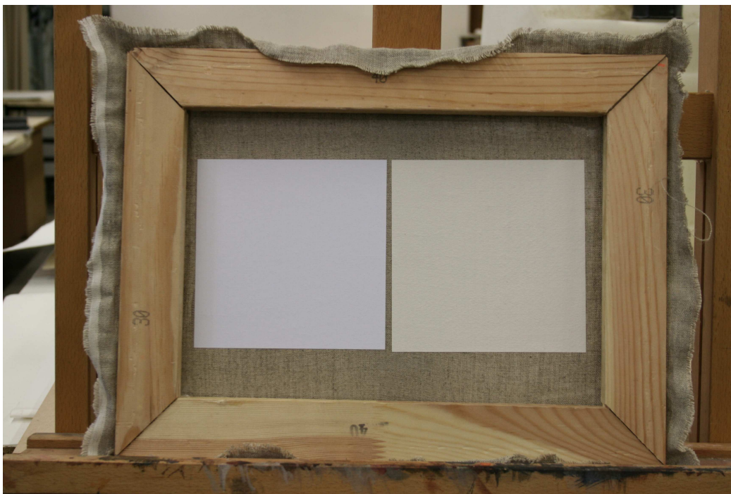
Obr. č. 12 Vzorky naaplikované na plátno napnuté na dřevěný blind rám.
