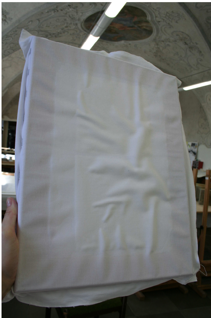
Obr. č. 14 Použití Klucelu G jako adheziva pro aplikaci papírové podložky na bavlněné plátno, pohled na zadní stranu.
