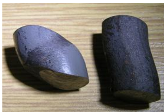
Obr.23 Deformace vzorků – délky větší než průměr vzorků
