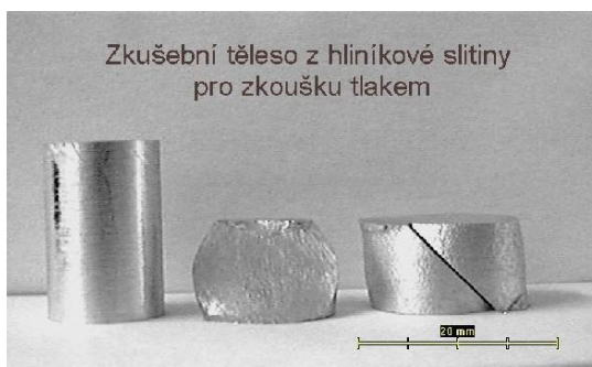
Obr.17 Zkušební těleso pro zkoušku tlakem – hliníková slitina [4]
