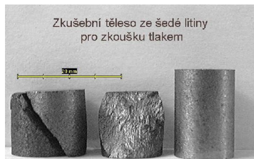
Obr.16 Zkušební těleso pro zkoušku tlakem – šedá litina [4]
