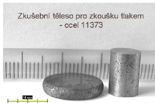
Obr.15 Zkušební těleso pro zkoušku tlakem – ocel 11373 [4]
