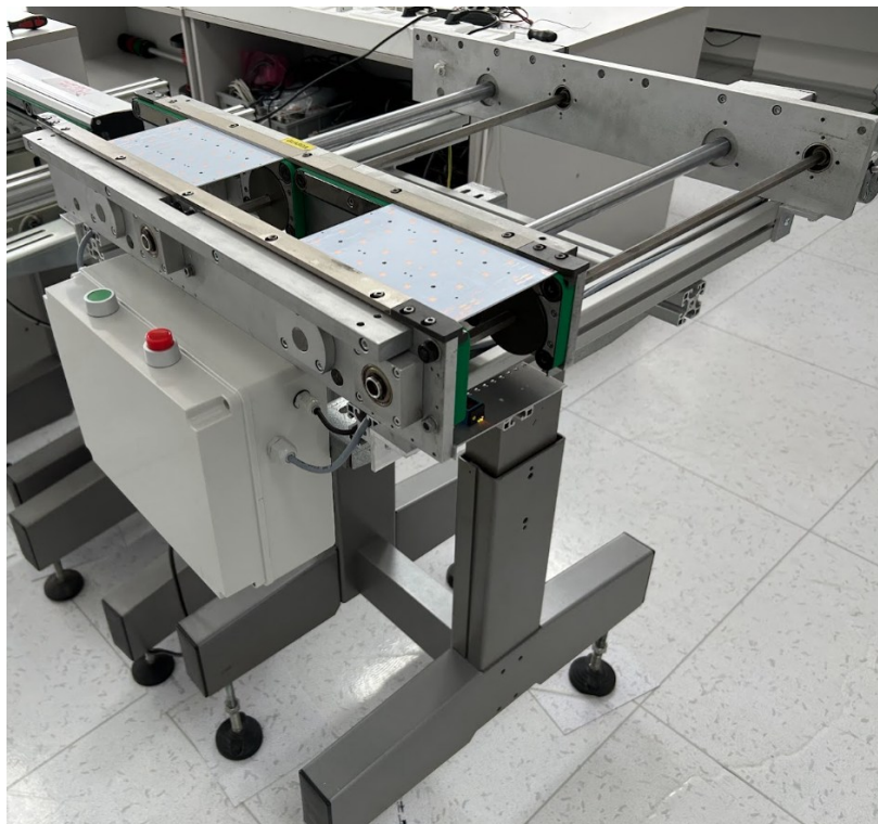
Obrázek 27 Mechanická konstrukce dopravníku: přední pohled
