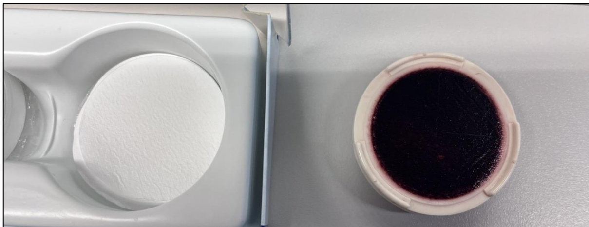
Obrázek 56: Na levé straně je čistý filtr ze skleněných vláken k záchytu částic nad 0,7 \mu\text{m} . Pravá strana obrázku zobrazuje filtr zanesený po filtrační předúpravě modelové vody, obsahující barvivo AR118 o koncentraci 0,5 \text{ g/l} .
