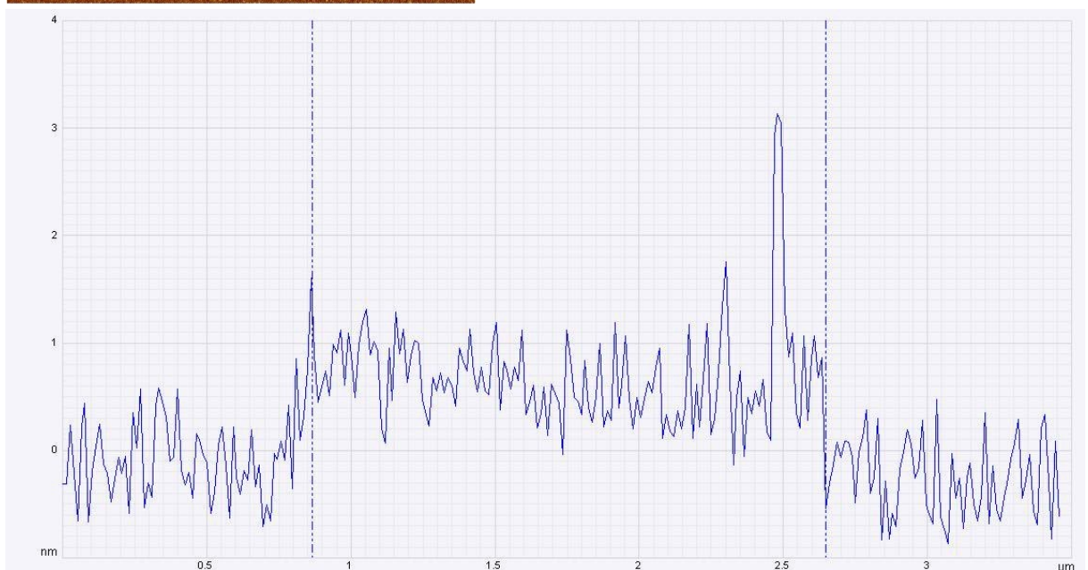
Obrázek 24 – Snímek AFM lístku GO a výškový profil (měřítko 6 μm)
