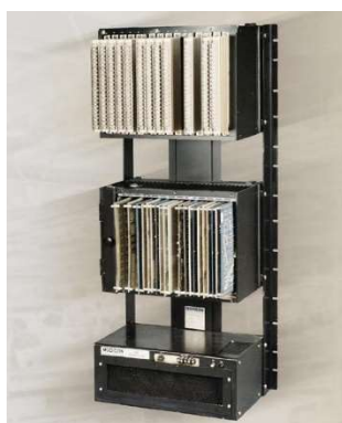
Obr. 3 Modicon 084, první PLC na světě (ceskestavby.cz, 2024)
