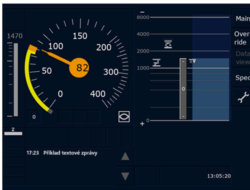
Obrázek 15 Monitor mobilní části ETCS (DMI)
