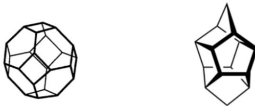
Obrázek 4: Sodalitová (vlevo) a pentasilová (vpravo) strukturní jednotka (vrcholy útvarů symbolizují atomy Si, popř. Al), zdroj (30)
