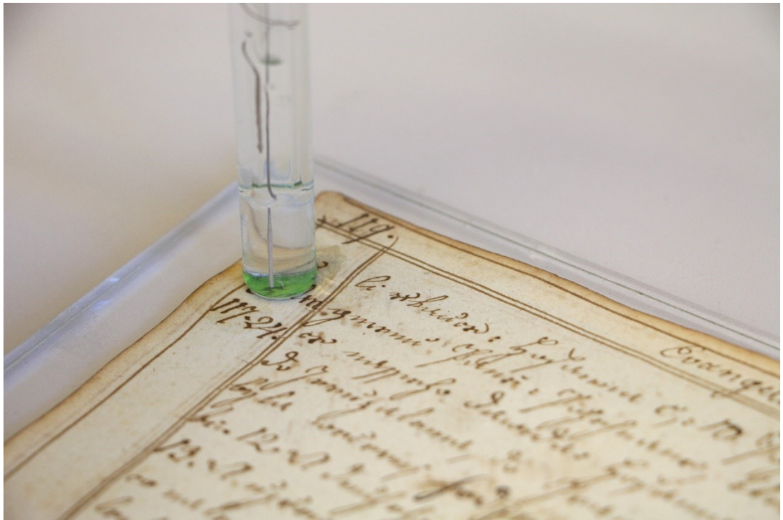
Fotografie 45 Měření pH papírové podložky
