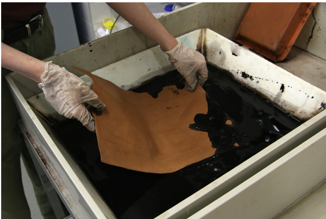
Fotografie 89 Moření usně pro výrobu záplat
