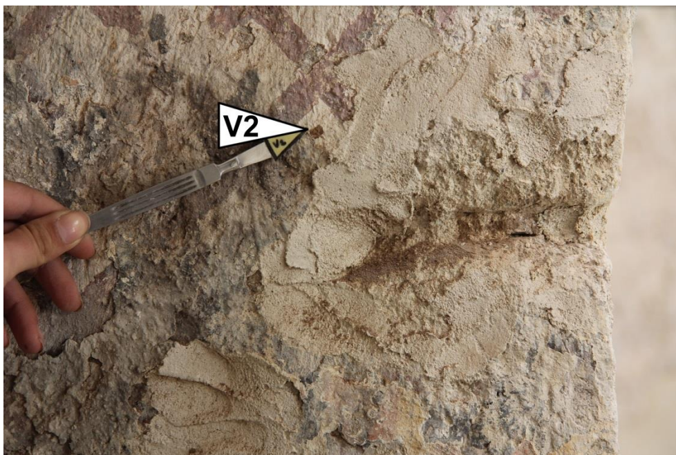
Obr. 71 Východní stěna vítězného oblouku, vzorek V2. Odběr z nástěnné malby mřížového ornamentu. Fotografie v rozptýleném osvětlení.
