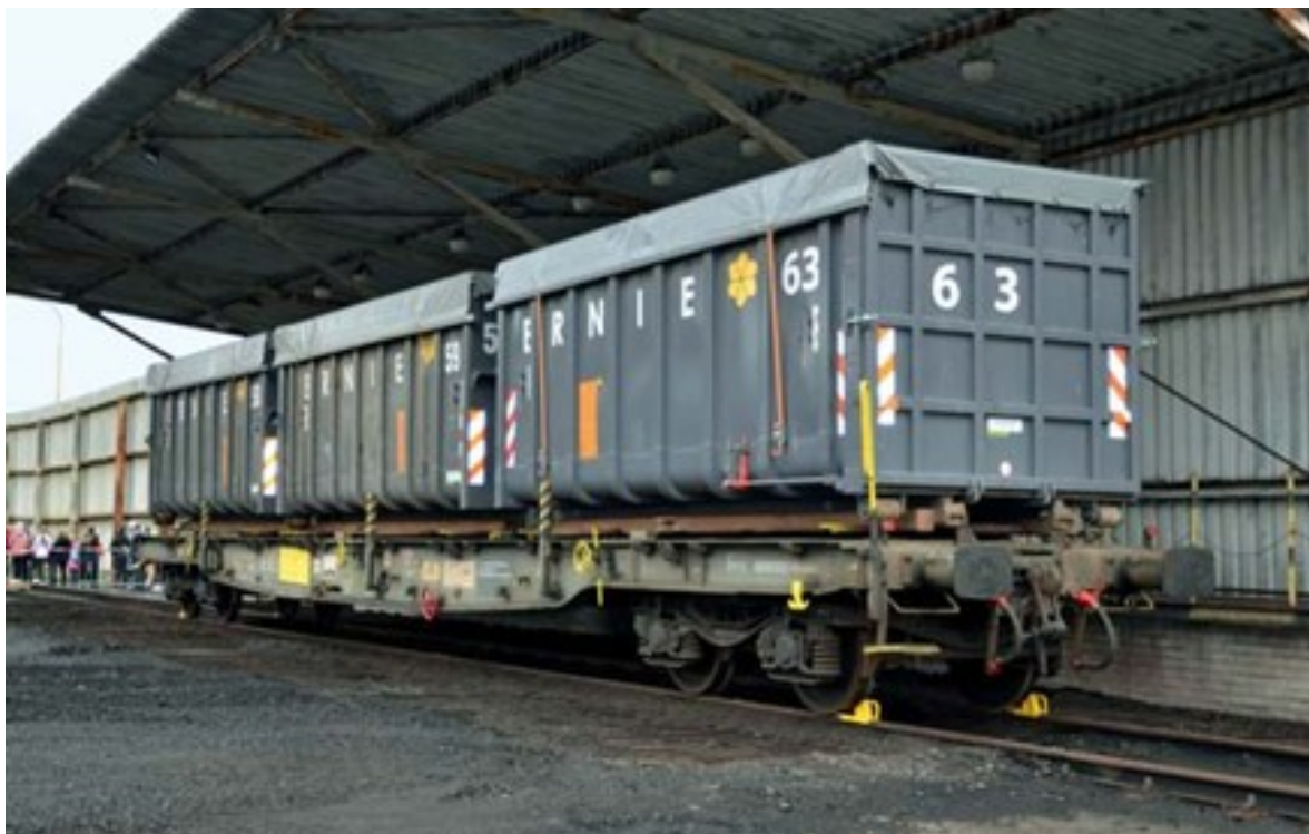
Obr. 17: Vůz Slps naložený kontejnery ACTS
