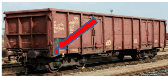
Obrázek 18 Návrh umístění sledovacího zařízení na vozu řady Eas a Eas-kov (ČD CARGO, 2019j, upraveno autorkou)
