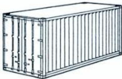
Obrázek č.2: Univerzální kontejner ISO 1C, 1CC o délce 6 m
