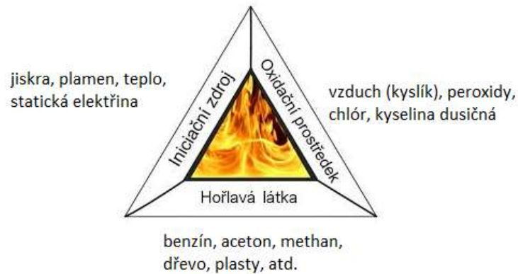
Obrázek 17 Požární trojúhelník a podmínky pro vznik hoření[29]
