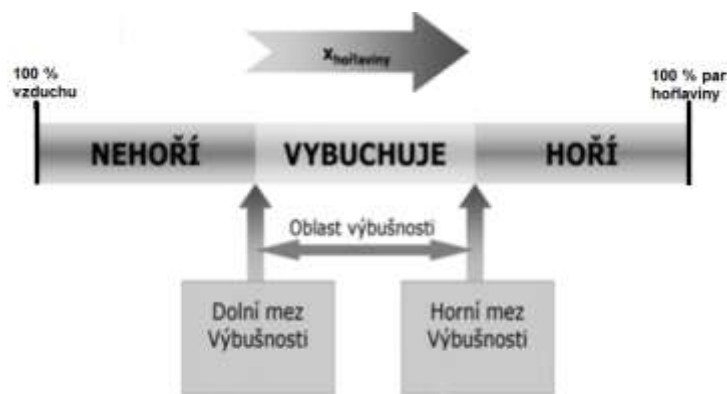
Obrázek 18 Schéma popisující stav směsi za různých podmínek .[30]
