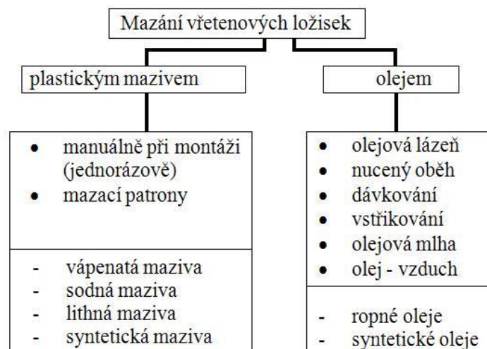
Obrázek 4. – Způsoby mazání vřetenových ložisek
