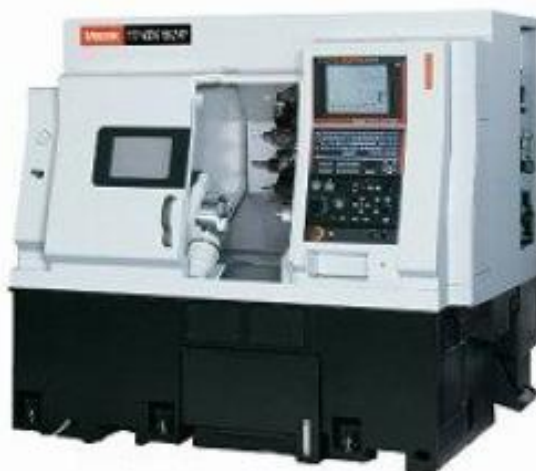
Obrázek 33. – CNC řízený soustruh se dvěma řízenými osami X a Z [25]
