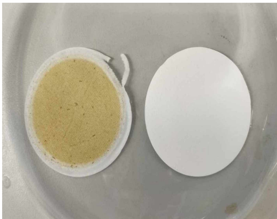
Obrázek 27 Zachycené nečistoty na membránovém filtru o porozitě 0,7 \mu\text{m} po filtraci vzorku vody z přírodního koupaliště Mělice
