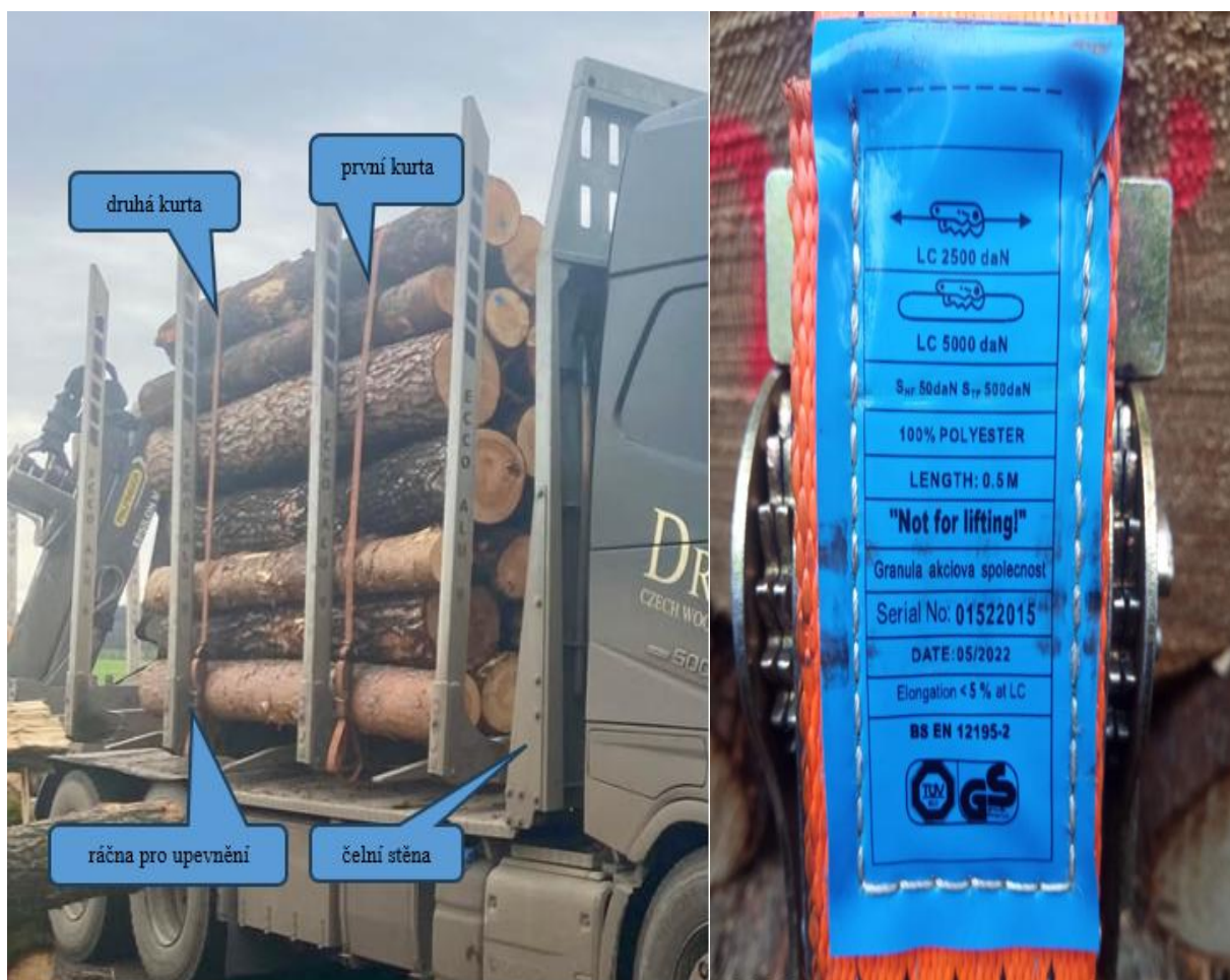
Obrázek 3 Upevnění dřeva a údaje o upevňovacích prostředcích
