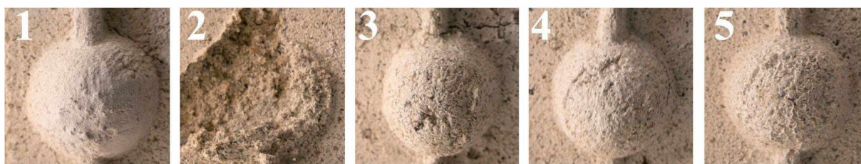
Obr. 55 Vliv separace formy na charakter povrchu otisku: 1) mramorová moučka, 2) včelí vosk, 3) 20% kličová voda, 4) mýdlo, 5) voda
