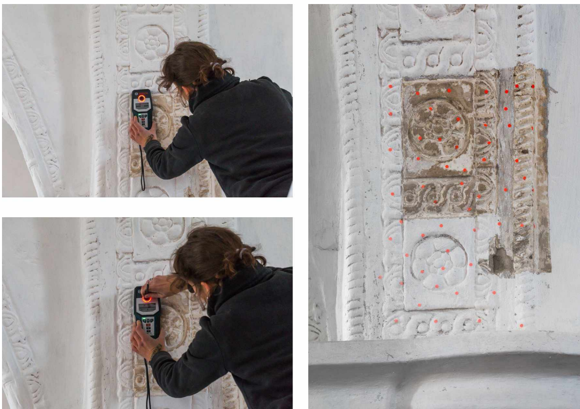
Obr. 34 Detekce kovových armatur pomocí detektoru GMS 120 Professional, vyznačení detekovaných kovových prvků napomáhá určit distribuci armatur, foto: Vojtěch Krajíček.
